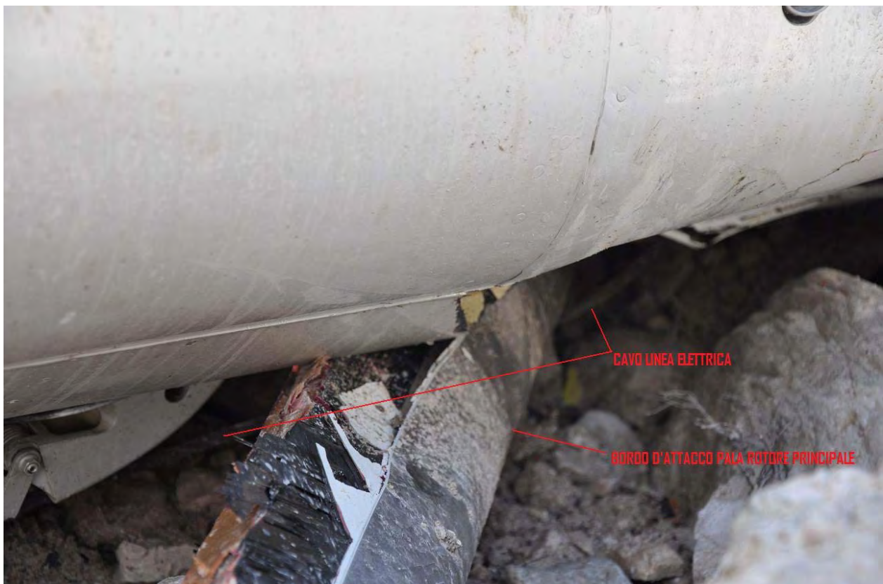
Foto 2: particolare del cavo elettrico sul rotore principale, sotto il relitto.
