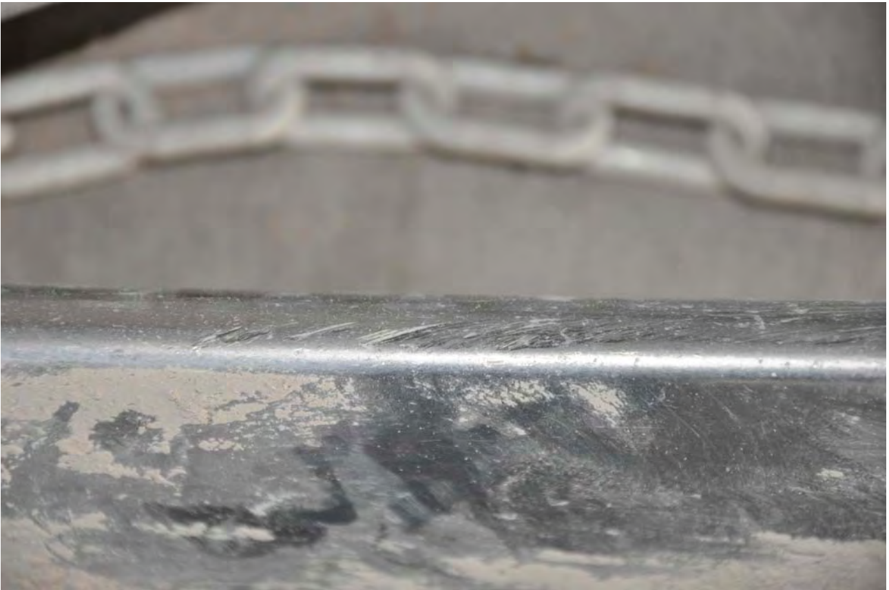
Foto 12: segni di impatto con i cavi sulla pala rotore principale ritrovata a valle del sito dell'incidente.
