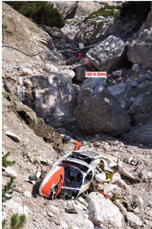
Foto 5: punto di impatto col terreno e tubo in gomma a monte dello stesso.
