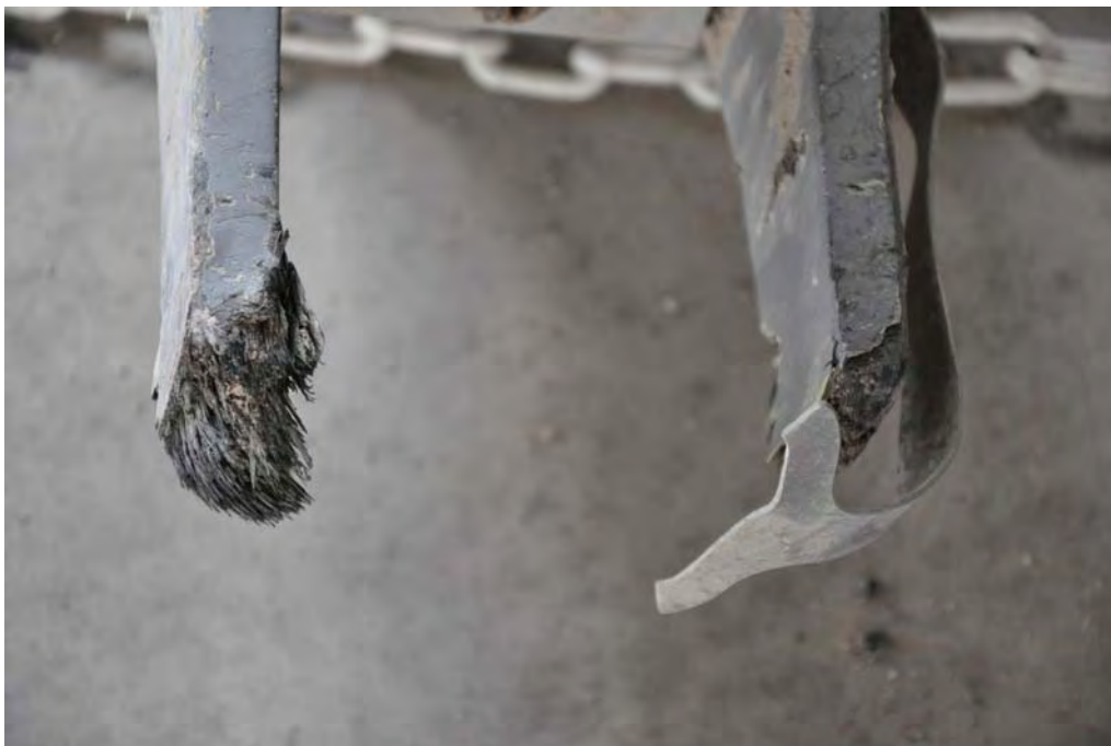
Foto 11: attacchi pala rotore principale ritrovata a valle del sito dell'incidente.
