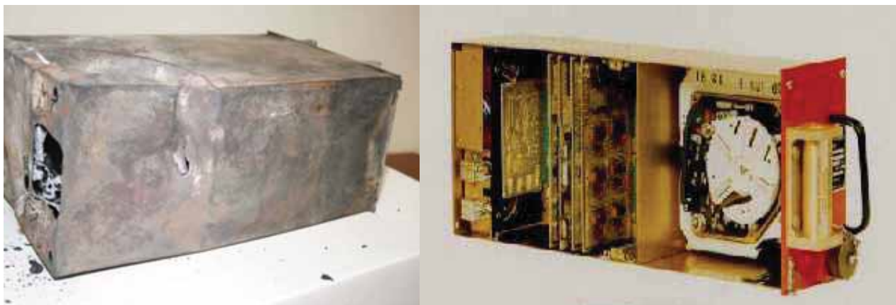
AB412 marche EC-JRY: confronto fra i CVR prima (a destra) e dopo l'incidente (a sinistra).
