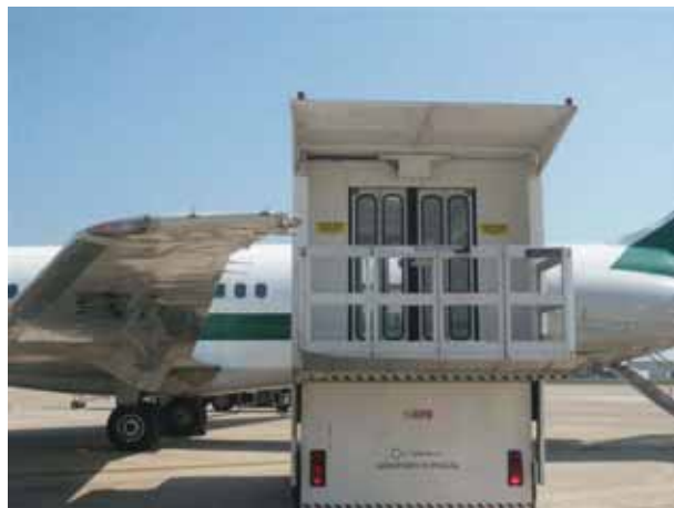
Danneggiamento della semiala sinistra del velivolo MD-80 marche I-DATM.
