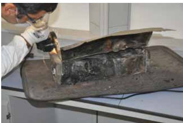
AB412 marche EC-JRY: a sinistra, apertura (FDR/CVR); a destra, rimozione memoria solida (FDR).
