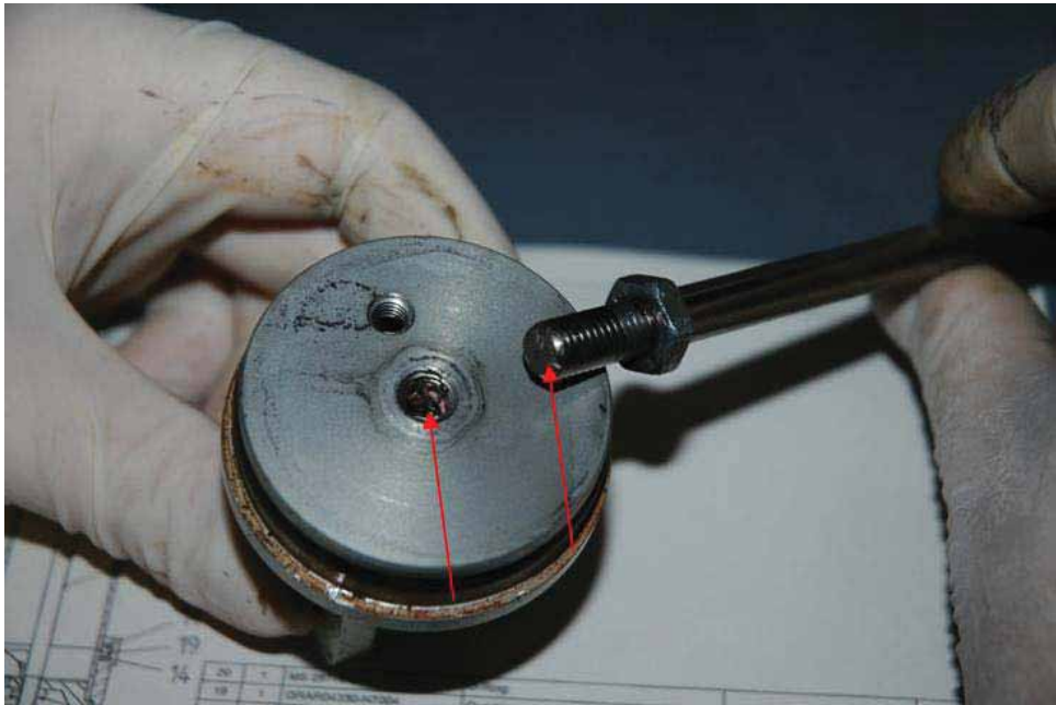
Residui “frena filetti” sull’ammortizzatore di un Diamond DA42 “TwinStar”.
