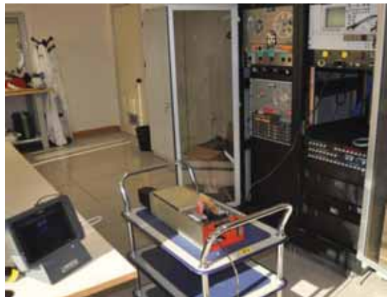
AB412 marche EC-JRY: a sinistra, rimozione memoria su supporto magnetico (CVR); a destra, sostituzione connettore e scarico dati tramite bench unit (FDR).
