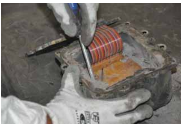
AB412 marche EC-JRY: a sinistra, apertura (FDR/CVR); a destra, rimozione memoria solida (FDR).
