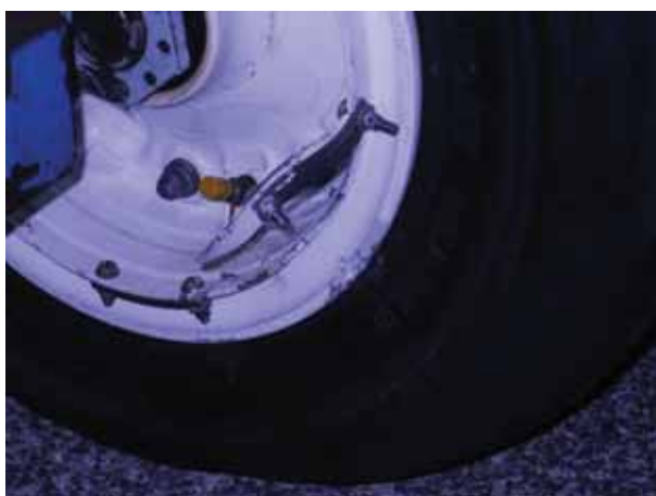
Danni al carrello anteriore di un CRJ 1000 durante la movimentazione in push back .
