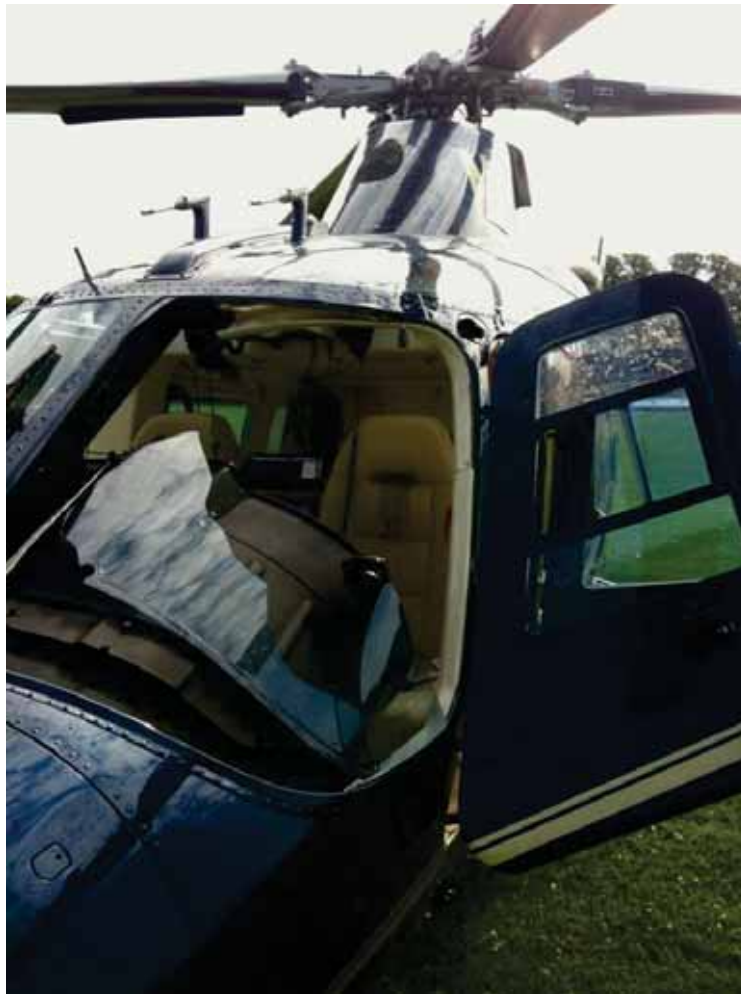
Danni da impatto volatile sull'A109 marche N109TK.
