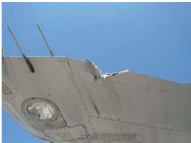
Danneggiamento della semiala sinistra del velivolo MD-80 marche I-DATM.
