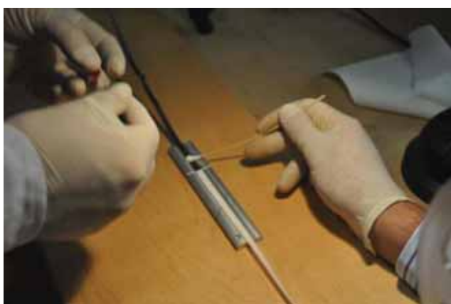
AB412 marche EC-JRY: a sinistra, ricostruzione e pulizia delle parti danneggiate (CVR); a destra, playback dei 4 canali audio (CVR).
