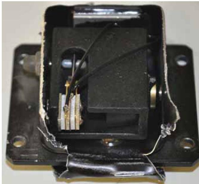
Impact Switch installato sulla flotta Bombardier 415.
