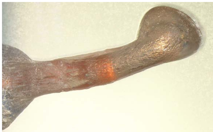
AW109E: forma del bulbo modificata dalle alte temperature raggiunte nel post impatto.
