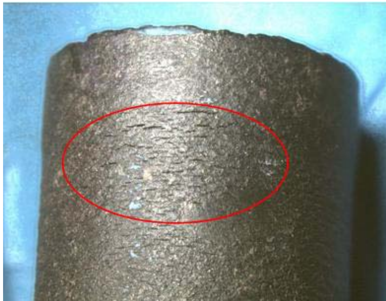
Cessna F150L: microfratture dovute a flessione dello stelo della valvola (lato sottoposto a tensione).
