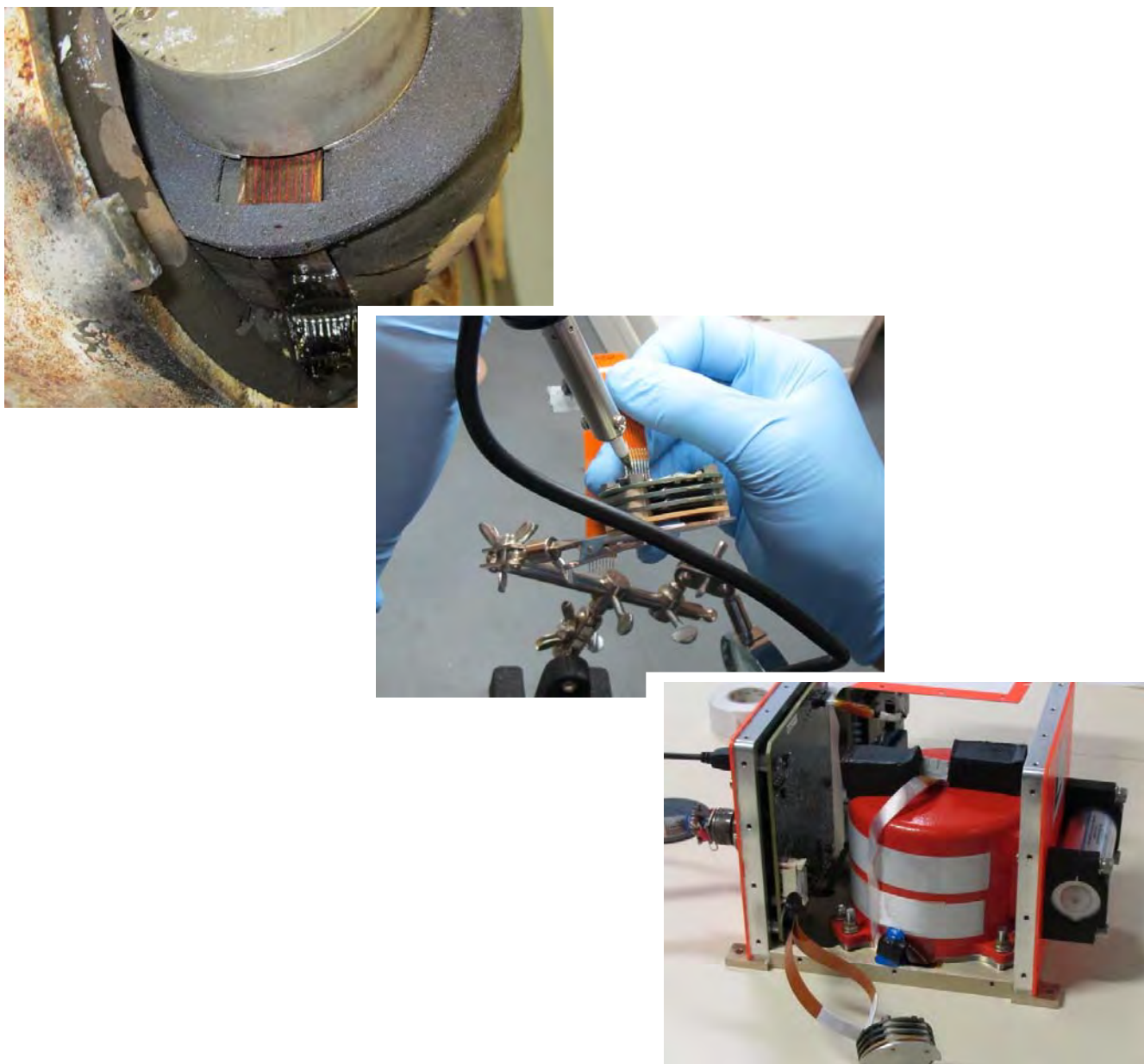
Alcune immagini delle operazioni condotte nei laboratori ANSV sul registratore di volo del M346.
