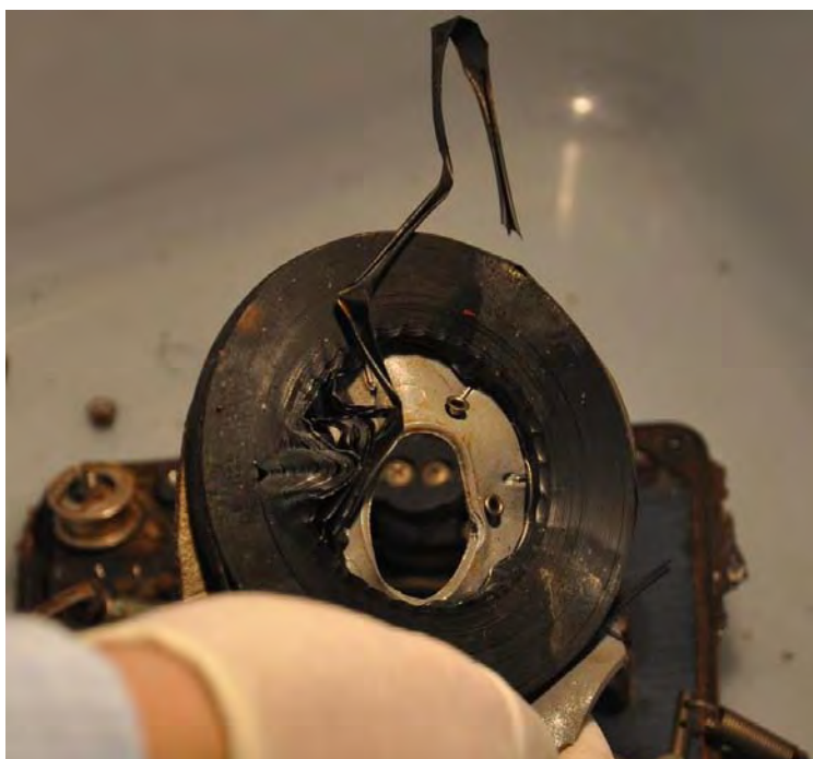
Attività per la CIAIAC: condizioni del supporto di memoria del CVR recuperato.
