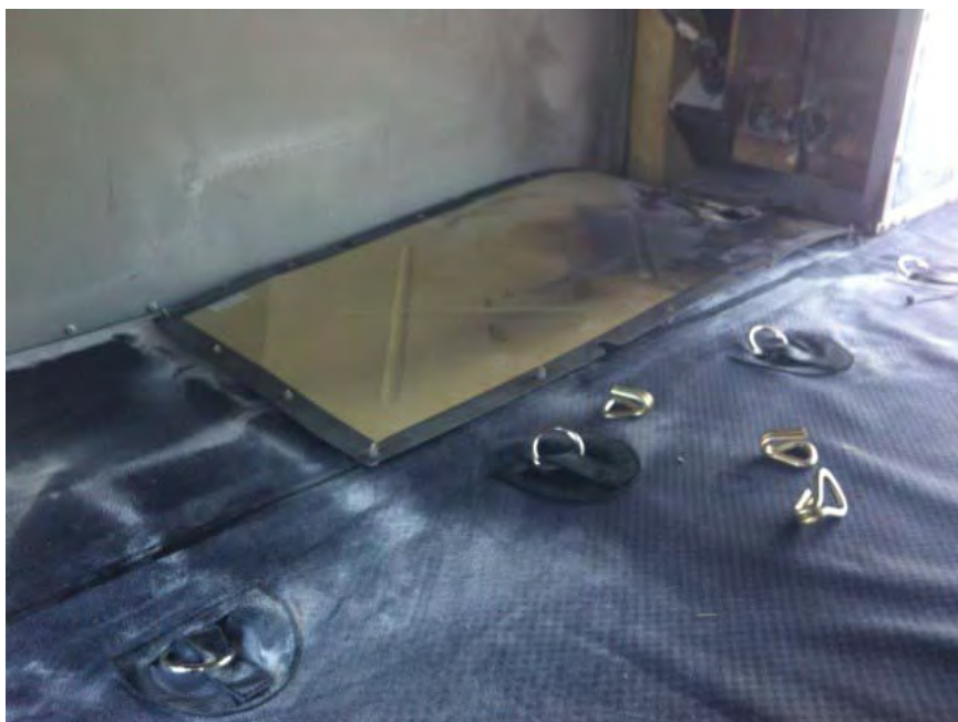
Bruciature da incendio all'interno del vano bagagli dell'elicottero AW139 marche I-RAIR.
