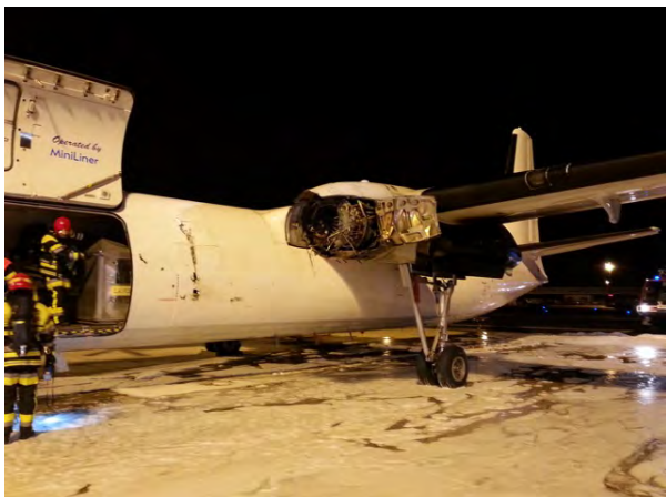
Vista dei danni riportati dal Fokker 27 Mk500 marche di identificazione I-MLVT.
