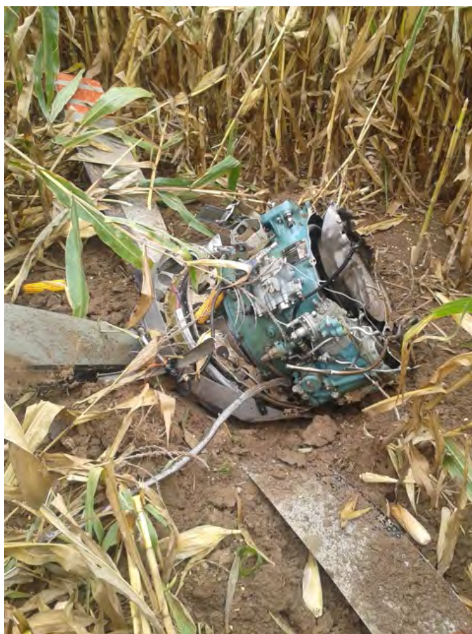
Quello che resta del complessivo dell'elica del motore sinistro dell'I-MLVT, rinvenuto in un campo agricolo.
