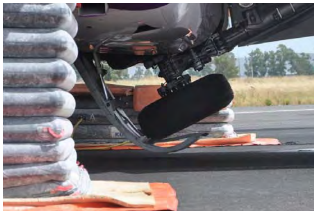
Portellone del carrello principale sinistro bloccato in posizione semiaperta.
