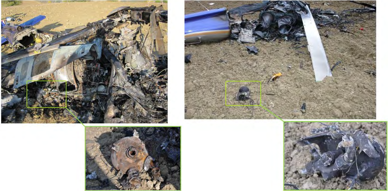
Stato di rinvenimento delle bombole estinzione incendio motore AW109E.
