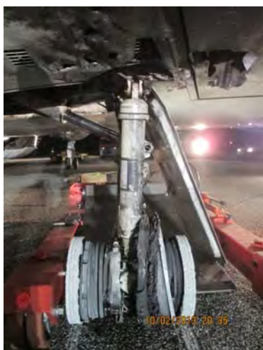
Danni al carrello di destra ed agli impennaggi di coda del N310GJ.
