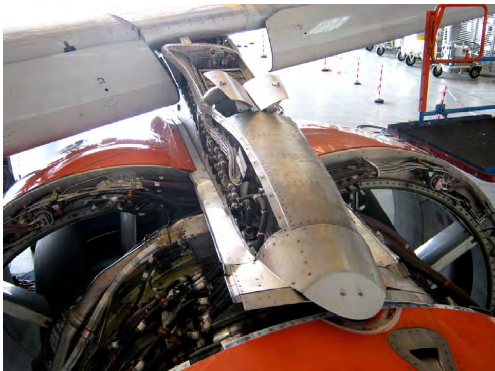
Significativa distorsione del pilone alare sinistro.
