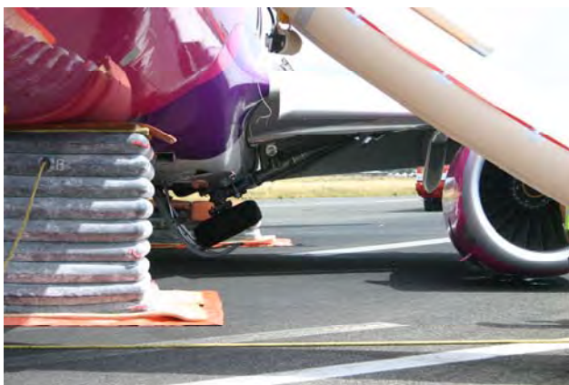
Portellone del carrello principale sinistro bloccato in posizione semiaperta.
