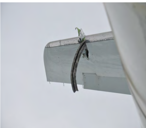
Danni al carrello di destra ed agli impennaggi di coda del N310GJ.
