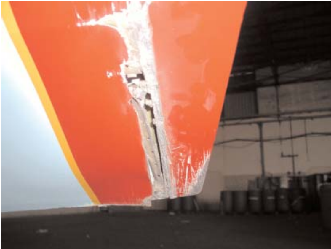
Particolare dell'alettone danneggiato
