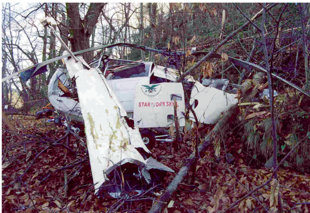
Elicottero incidentato – vista laterale con trave di coda spezzata
