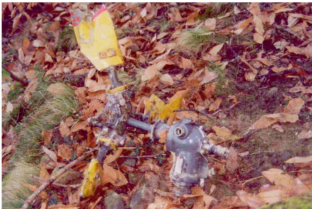
Particolare rotore di coda – mozzo e pale
