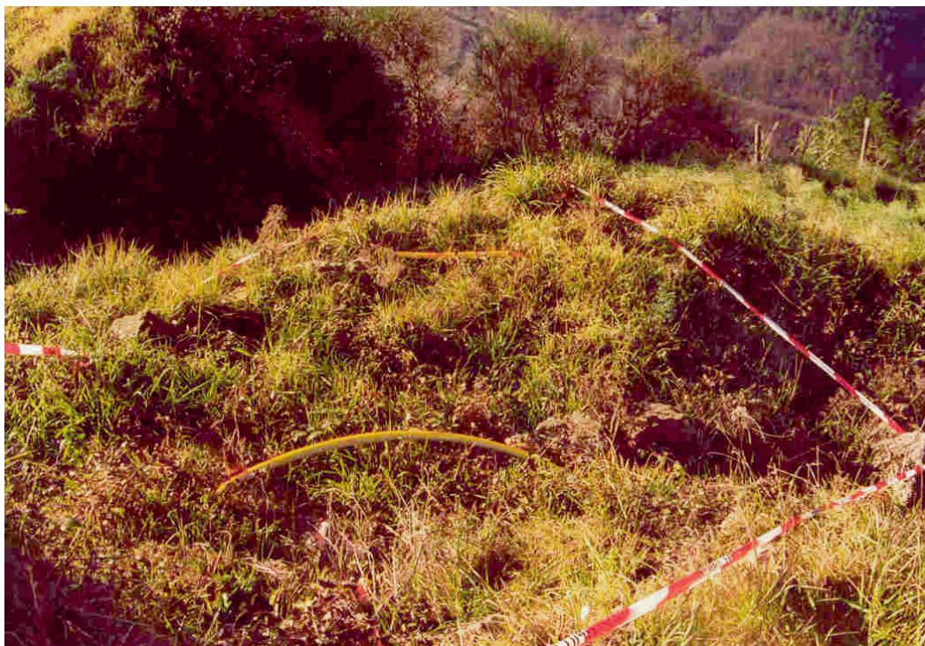
Parti della bequille spezzatasi in volo – asta posta in prossimità del rotore di coda dell'elicottero
