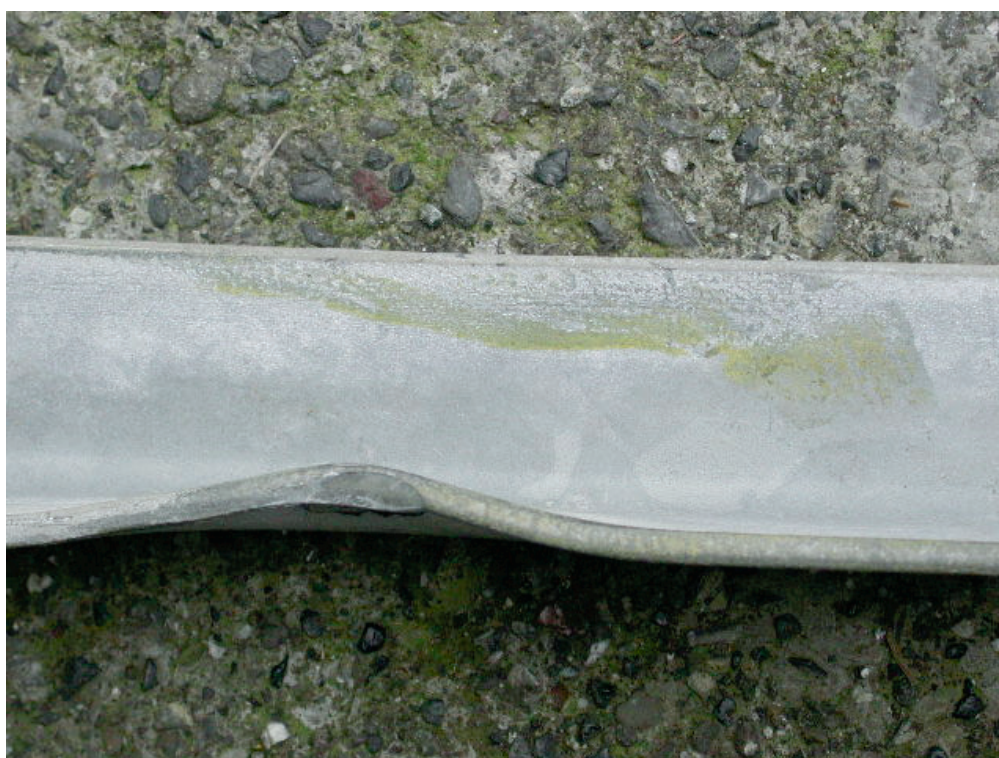
Particolare della deformazione della barra – notare i segni di colore giallo simile a quello delle pale del rotore di coda
