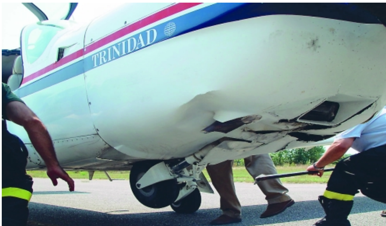
Danni alla carenatura del motore e al carrello anteriore.
