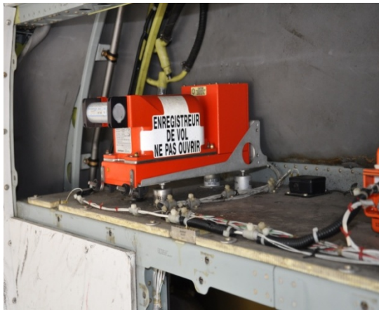
Foto 6: sbarco degli apparati FDR e CVR.
