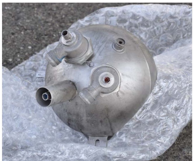
Foto 8 e 9: sostituzione fire extinguisher bottle.
