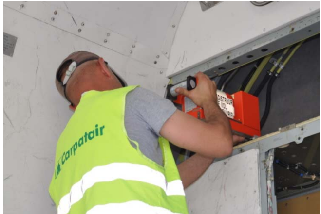
Foto 6: sbarco degli apparati FDR e CVR.
