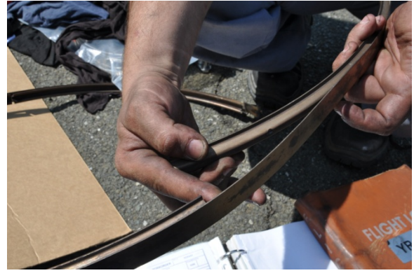
Foto 10 e 11: particolare di parte del motore di sinistra ALLISON AE 2100A e del V-band clamp.
