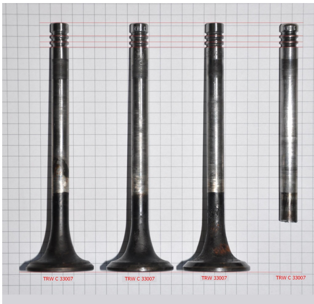
Foto 11: stato delle valvole di scarico smontate dal motore, con l'indicazione, in basso, del rispettivo "P/N"; sull'estrema destra, la valvola di scarico del cilindro n. 2.
