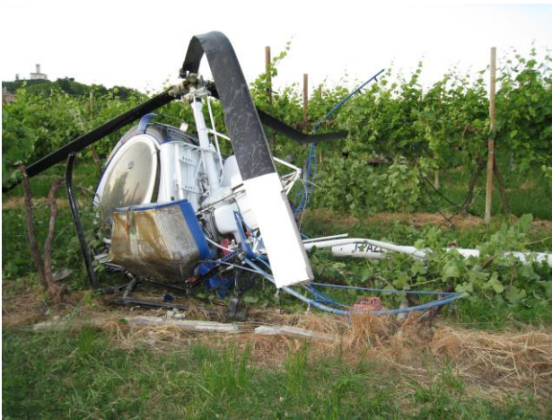
Foto 3 e 4: particolari del piegamento delle pale del rotore principale.
