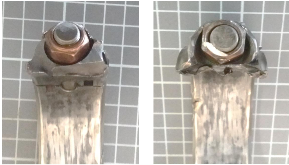
Foto 15 e 16: superfici di rottura cappello di biella ("A" sulla sinistra e "B" sulla destra).
