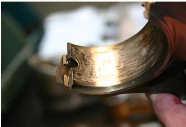
Foto 9, 10, 11 e 12: evidenze di fretting e galling sulle bielle pistoni.
