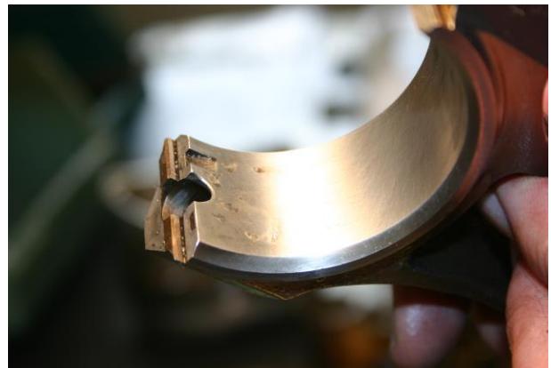
Foto 9, 10, 11 e 12: evidenze di fretting e galling sulle bielle pistoni.
