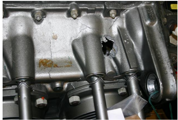
Foto 7 e 8: danneggiamento carter motore in corrispondenza del pistone n. 4.
