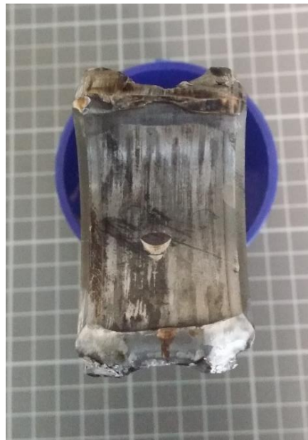
Foto 14: danneggiamenti delle superfici di rottura della biella.
