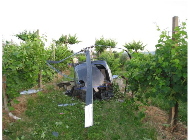
Foto 3 e 4: particolari del piegamento delle pale del rotore principale.
