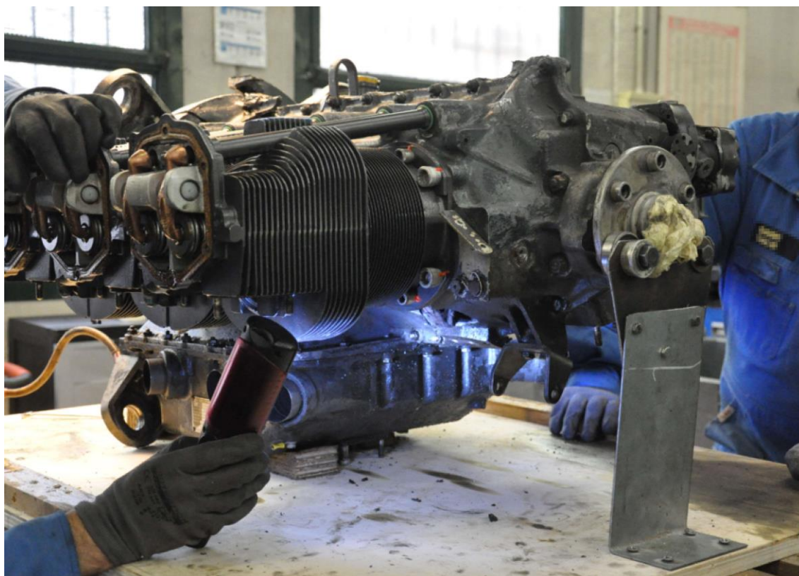
Foto 5: rottura del carter inferiore del motore, all'altezza del cilindro n. 1.
