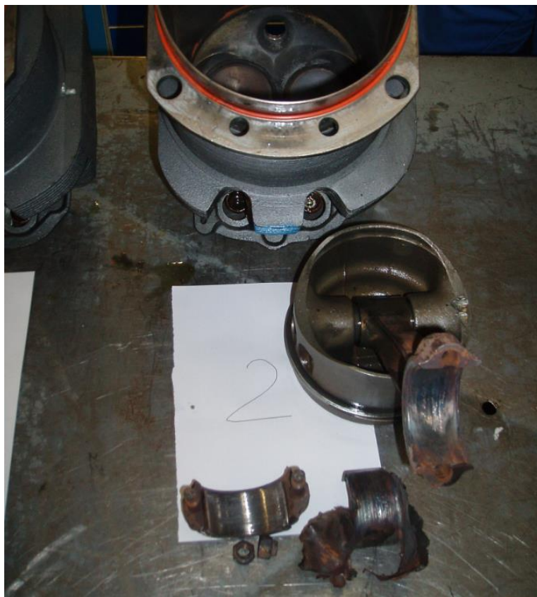
Foto 10: particolare del pistone n. 2 e relative bronzine.
