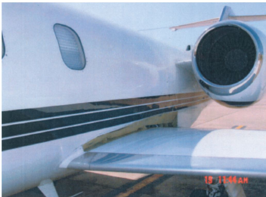
Particolare danni attacco semiala-fusoliera.
