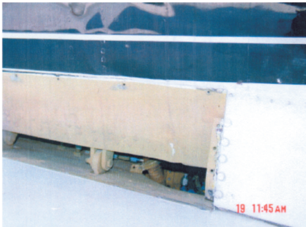
Particolare danni attacco semiala-fusoliera.
