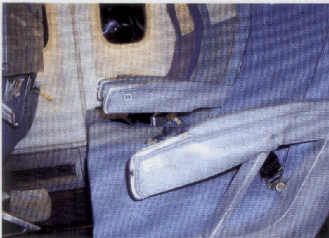
右側通路座席35の通路側肘掛けの損傷
