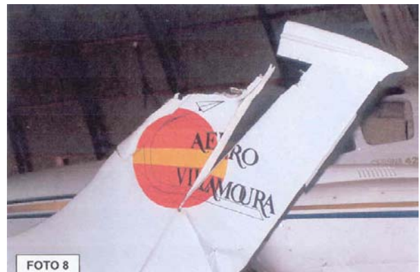
Fig. 6 – Estabilizador vertical com a parte superior destruída e o leme de direcção dobrado a meio.
