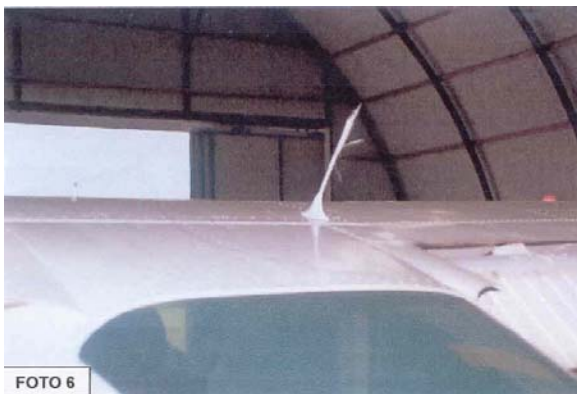
Fig. 5 – Antena de VHF.
