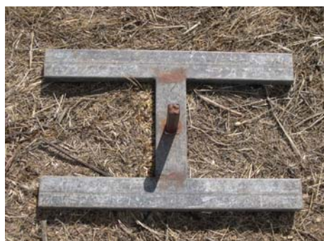
Fig. 10 - Base do poste.
