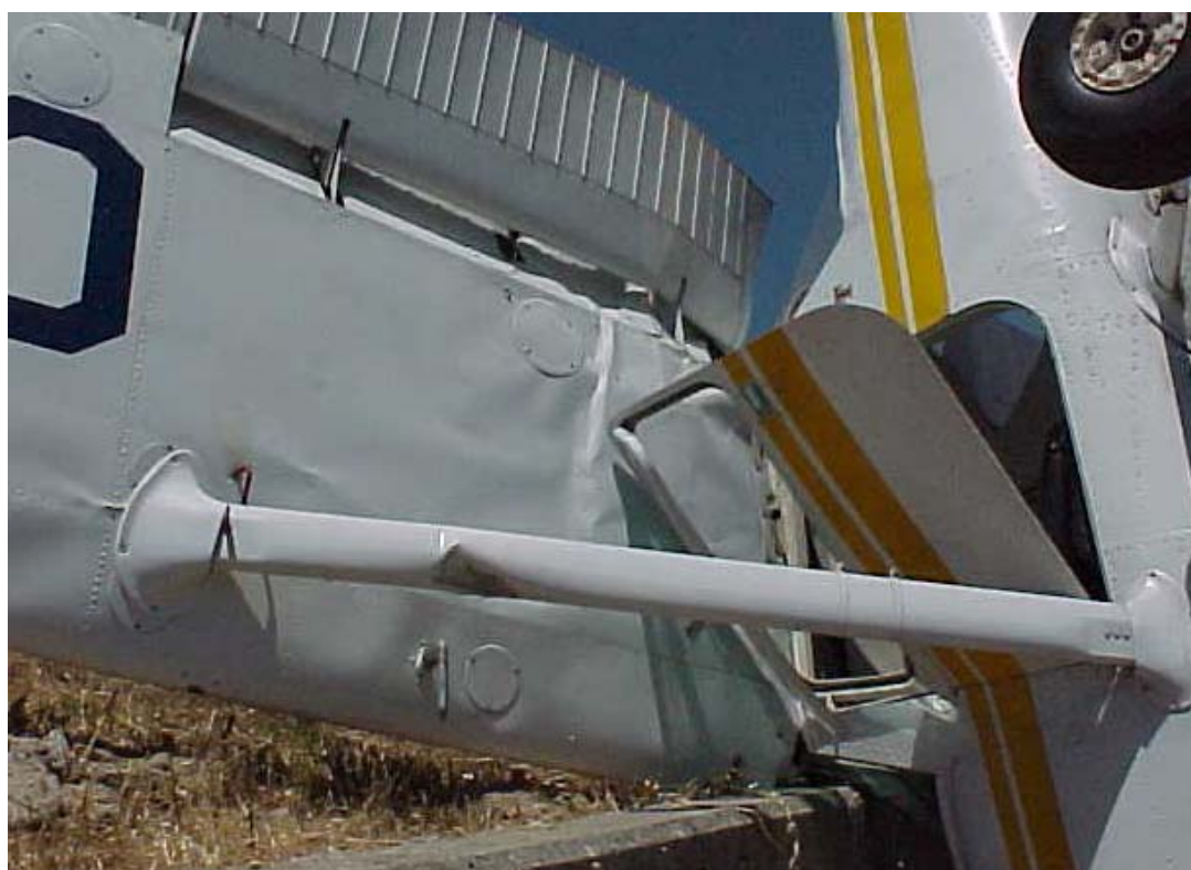
Foto 12 – Cabina e raiz da asa
