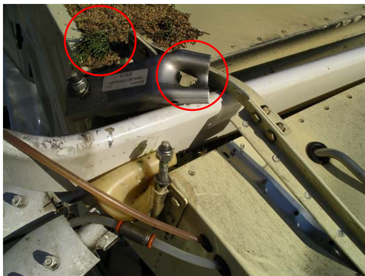
Fig. 11 – Furo degolado do fixador do trem.
