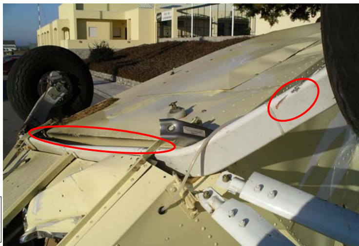
Fig. 10 – Estrutura solta do berço e vestígios do embate no poste de electricidade.
