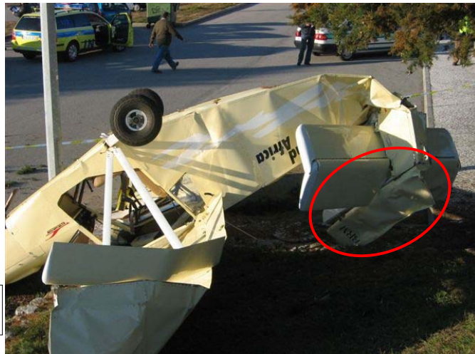
Fig. 9 – Aspecto da empenagem deformada.
