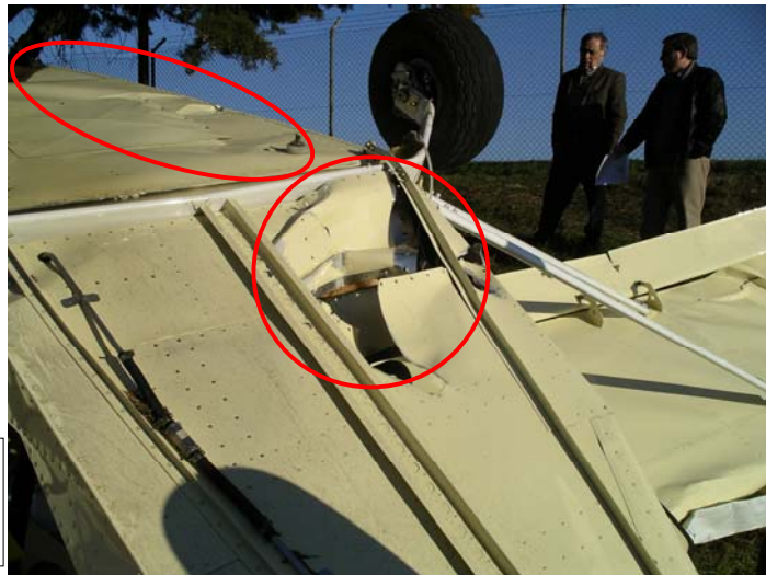
Fig. 8 – Rombo sob a cadeira do piloto e ondulação do revestimento do intradorso da fuselagem.
