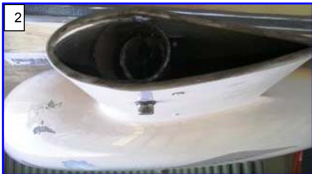
Fig. N°2 & 3 – Danos na estrutura do trem de proa.
