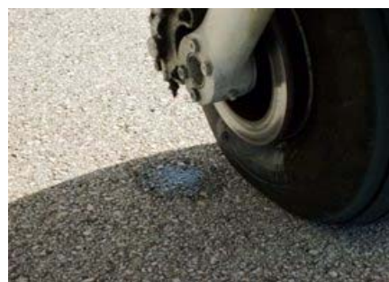
Fig. Nº3. Derrame de óleo
