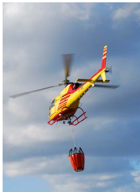
Fig. 4 - O Eurocopter com o Bambi Bucket .
