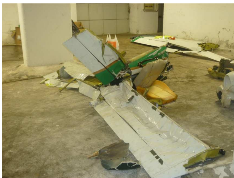
Fig. 16 - Estado geral de deformação da cauda da aeronave (leme de profundidade, leme de direcção e estabilizador vertical).
