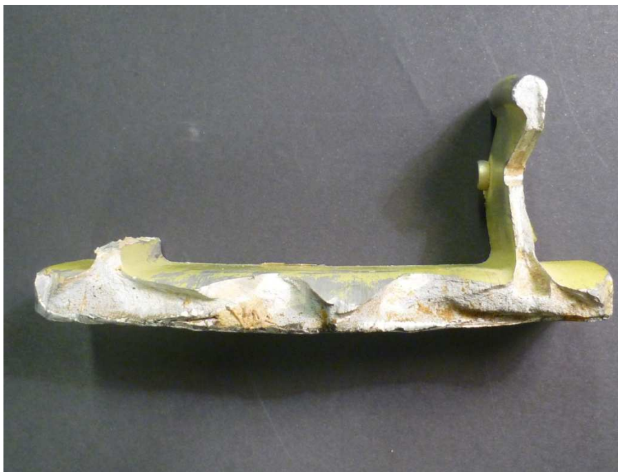
Fig. 2 – Superfície de fractura da longarina principal da asa.
