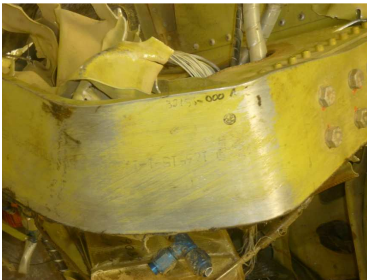
Fig. 4 – Imagem de marcas de raspagem localizadas numa das mesas da longarina principal da asa.
