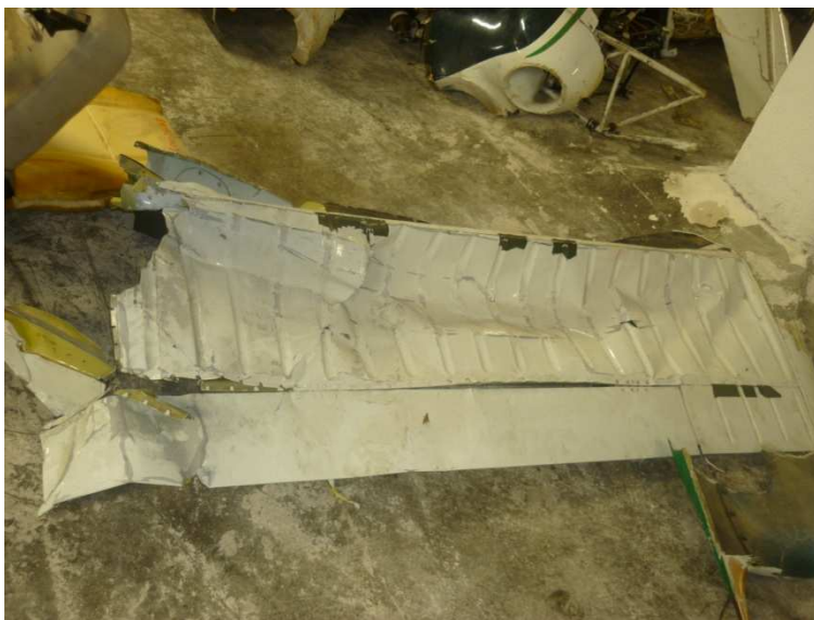
Fig. 17 – Deformação do revestimento do leme de profundidade em torno da longarina principal.
