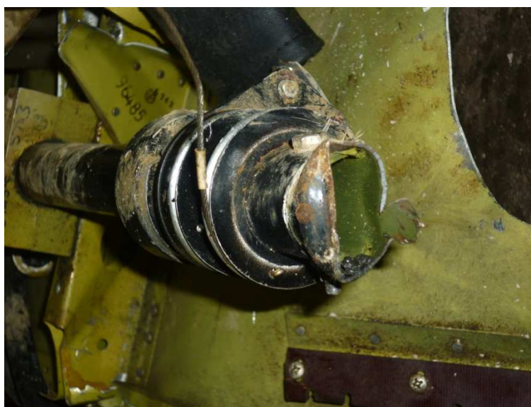
Fig. 15 – Deformação do tudo de accionamento dos flaps na zona de fractura.
