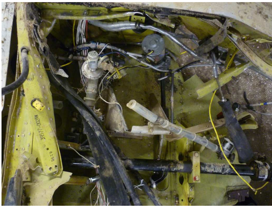
Fig. 12 – Sistema de accionamento dos flaps instalado na zona central da fuselagem.
