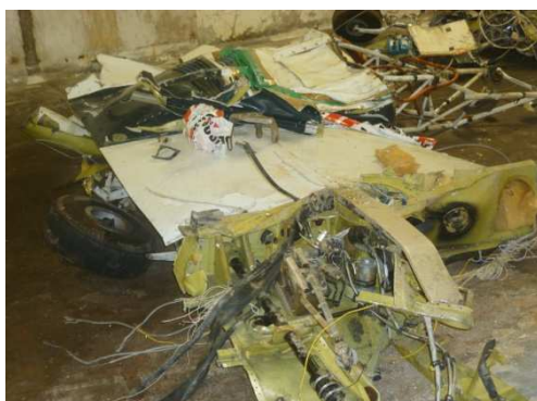
Fig. 7 - a) Estado geral de deformação da asa esquerda; b) pormenor da deformação da longarina da asa esquerda junto à raiz.
