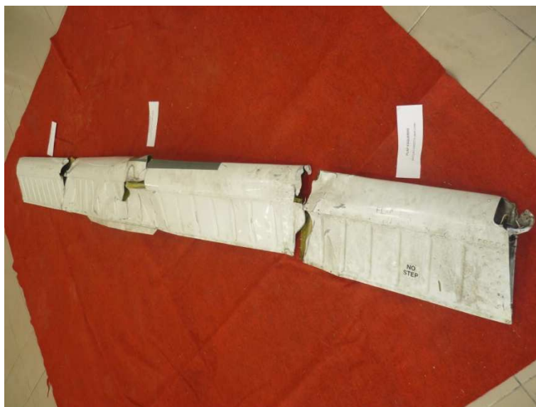
Fig. 9 – Flap da asa esquerda, com sinais evidentes de arrancamento na zona de fixação à asa, junto aos apoios e articulações.
