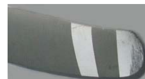
Fig.2 – Deformação numa das pás do hélice.
