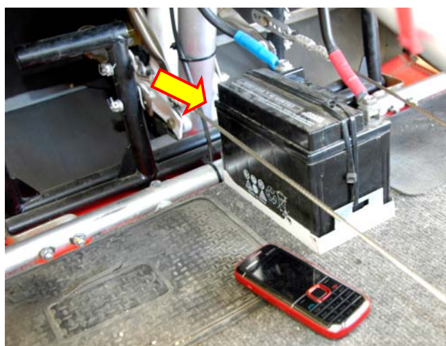
Fig. 15 – Local da bateria (As dimensões do telemóvel dão ideia do tamanho de uma bateria original)
