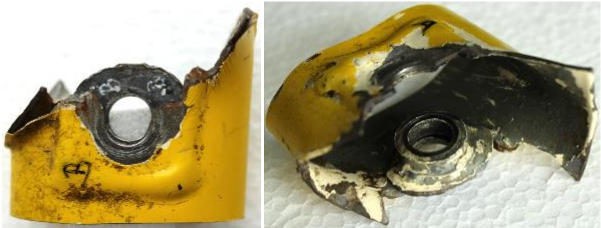
Obr. 4 Přehledové snímky vzájemné polohy protikusů porušené vzpěry u otvoru B.
