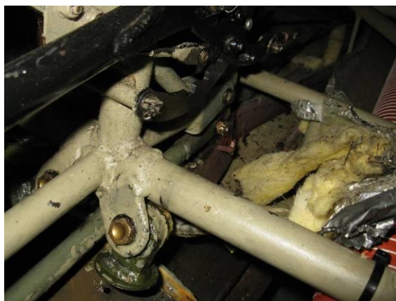
Deformace spodní příčné lišty uchycení potahu
