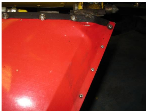
Poškození krytu trojúhelníkových vzpěr
