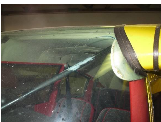
Prasklé čelní sklo kabiny ve výhledu pilota
