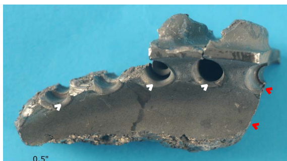
Obrázek č. 5 Pohledy zobrazující přední (A) a zadní (B) stranu fragmentu kola třetího stupně (zdroj Honeywell)
