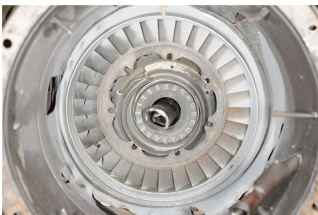
Poškození statoru 2. stupně turbíny – zadní strana.
