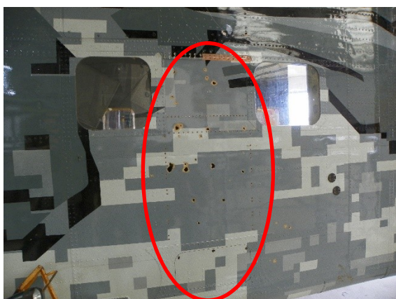
Obrázek 2. Poškození trupu letadla a palivové nádrže.
