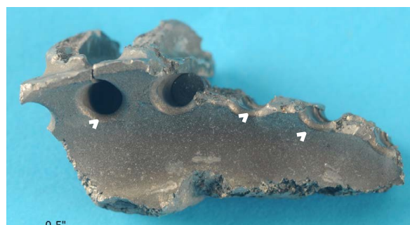
Obrázek č. 5 Pohledy zobrazující přední (A) a zadní (B) stranu fragmentu kola třetího stupně (zdroj Honeywell)
