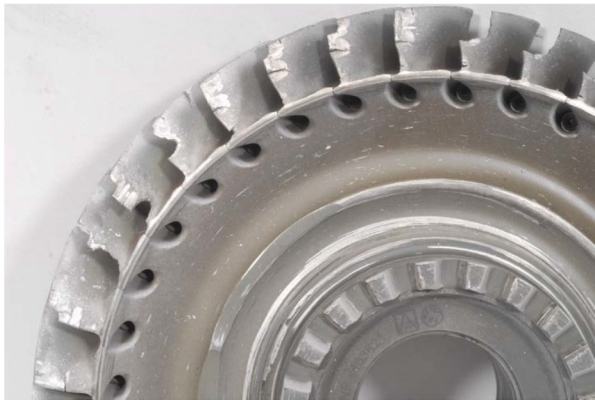
Poškození kola 1. stupně turbíny – zadní strana.
