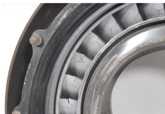
Trhliny na lopatkách statoru 1. stupně turbíny.
