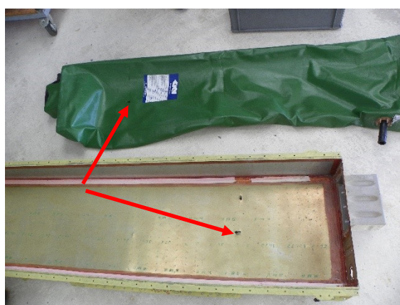
Obrázek 2. Poškození trupu letadla a palivové nádrže.
