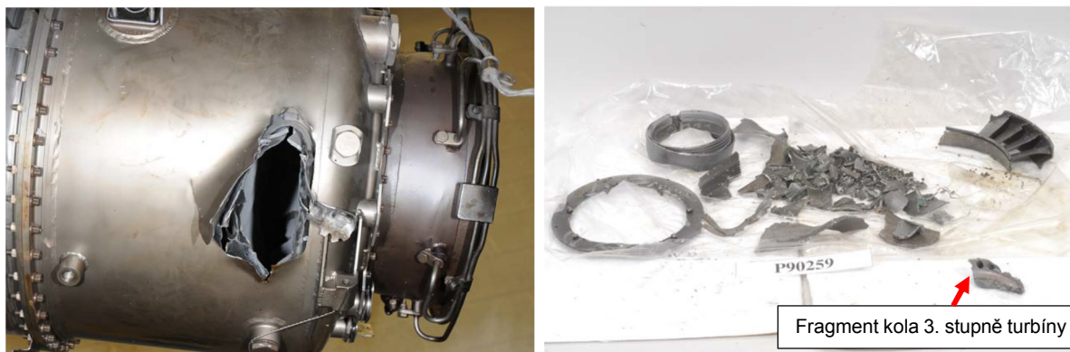
Obrázek 3. Proražené těleso spalovací komory v místě 3. stupně turbíny a úlomky (zdroj Honeywell).
