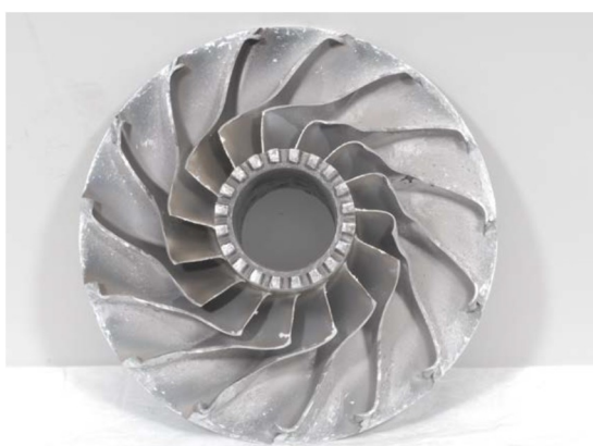
Poškození kola kompresoru 2. stupně.
