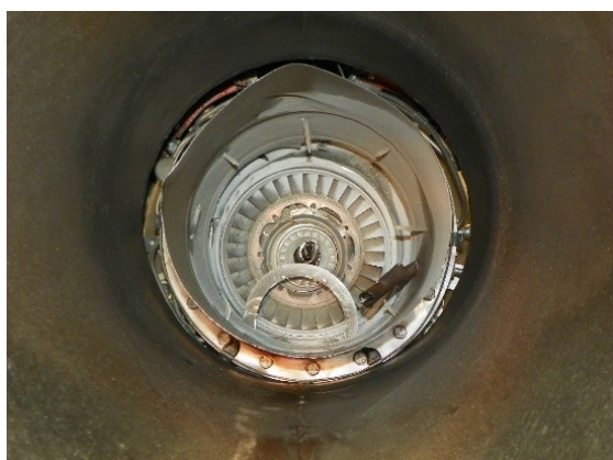
Pohled zezadu do motoru č. 2 a detail poškození.
