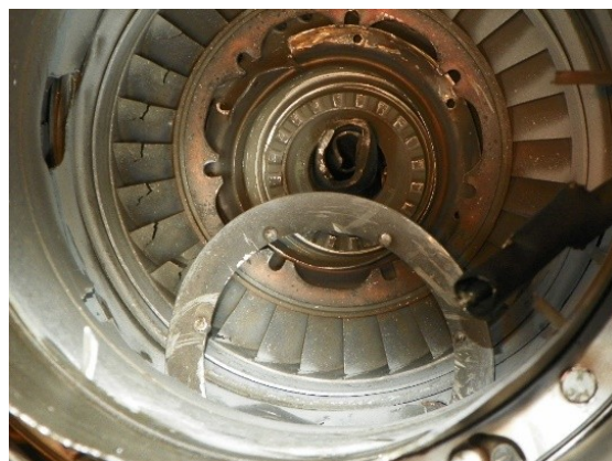
Pohled zezadu do motoru č. 2 a detail poškození.
