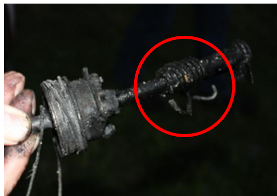
Mechanismus podélného vyvážení.
