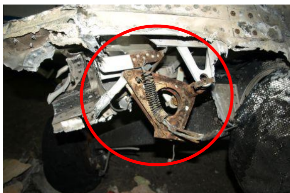
Mechanismus levé vztlakové klapky.
