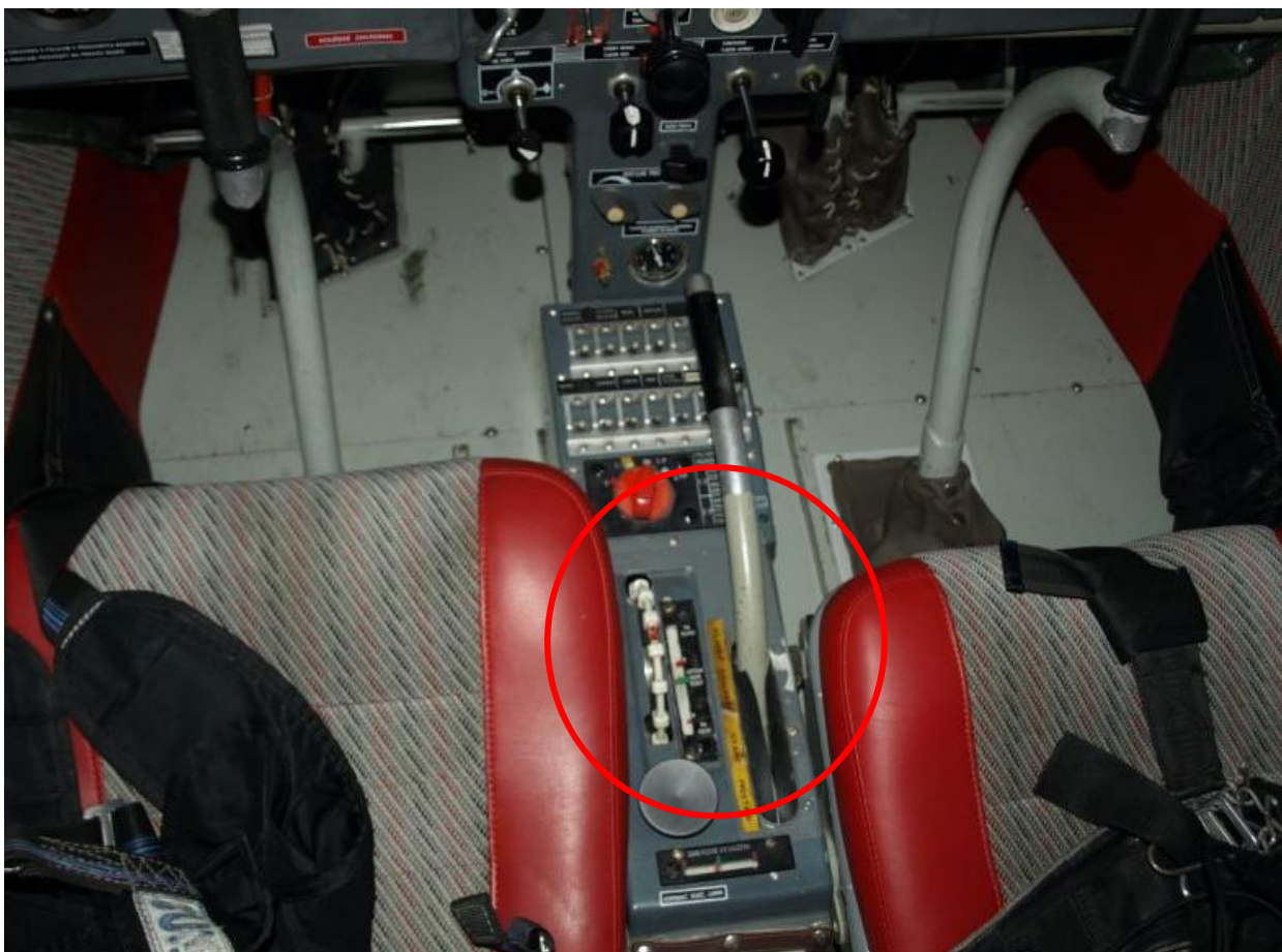
Ovládání vztlačových klapek a nastavování podélného vyvážení, levé sedadlo v přední poloze.
