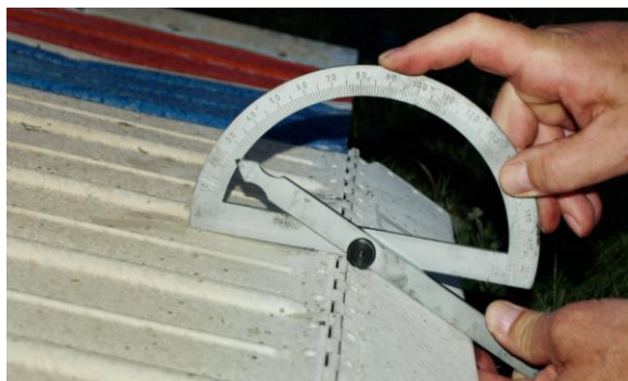
Výchylka plošky podélného vyvážení.
