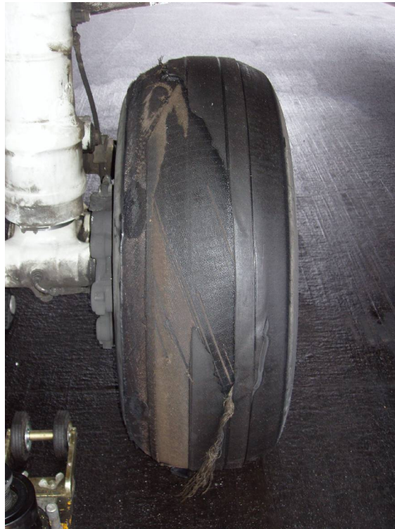
Poškozená pneumatika na kole č. 4
