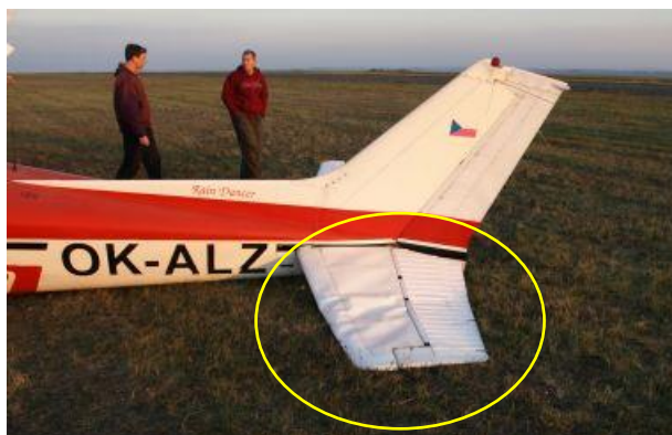
Poškození zadní části trupu a ocasních ploch
