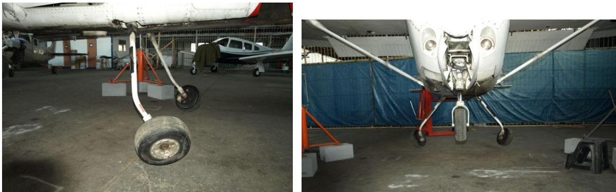
Poloha kol a nejnižší dolní poloha hl. podvozku při vysouvání
