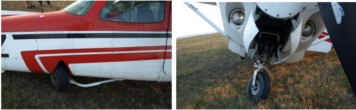
Poloha hlavního a předního podvozku po přistání
