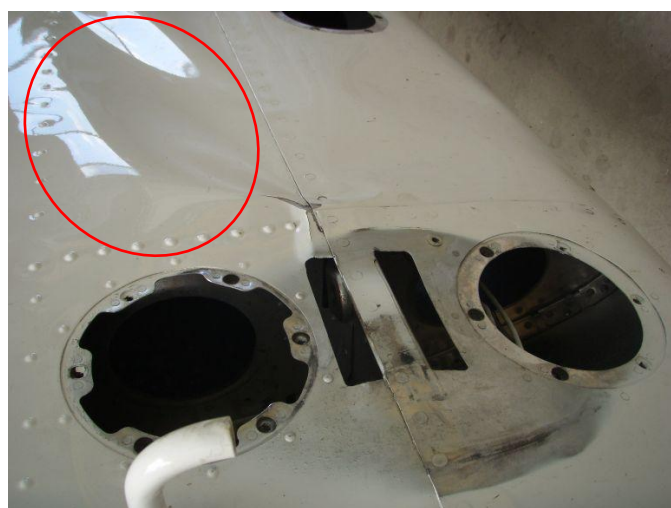
... zvlnění potahu křídla
