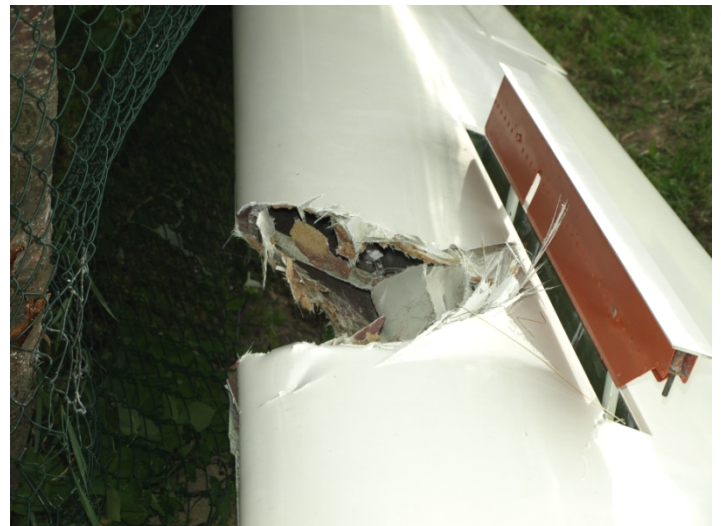
Destrukce náběžné hrany nárazem pravé poloviny křídla do kmene stromu a sloupku plotu
