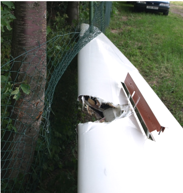
Destrukce náběžné hrany nárazem pravé poloviny křídla do kmene stromu a sloupku plotu
