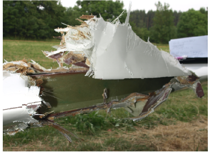
Destrukce náběžné hrany nárazem levé poloviny křídla do kmene stromu
