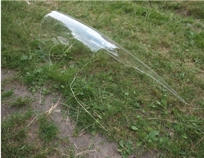
Rozbitý překryt pilotní kabiny - část
