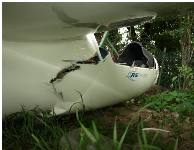
Destrukce pravé strany trupu za pilotní kabinou
