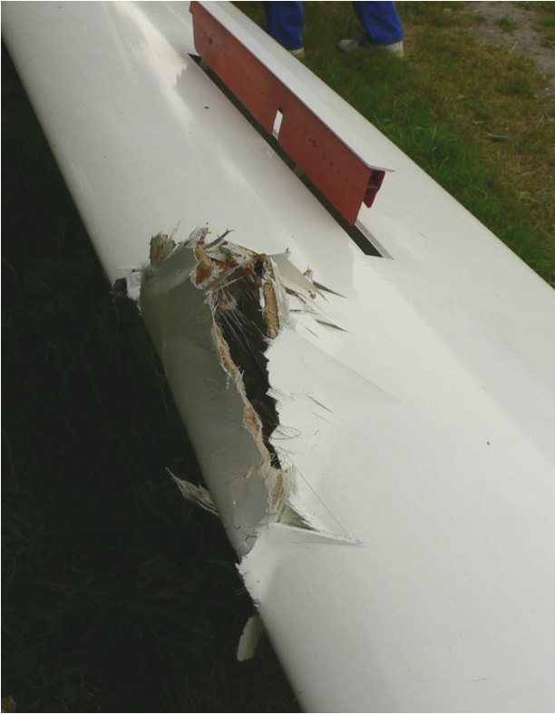
Destrukce náběžné hrany nárazem levé poloviny křídla do kmene stromu
