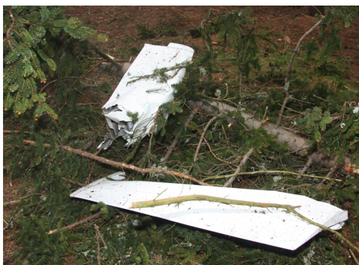
Odtržená levá polovina stabilizátoru a výškového kormidla
