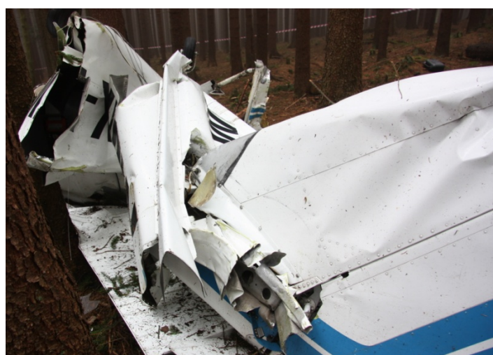
Destrukce zádi letounu a levé poloviny VOP
