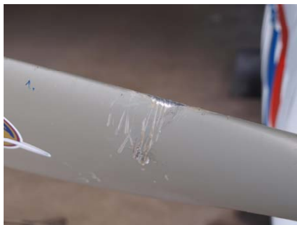
Detail poškození listu vrtule č. 1
