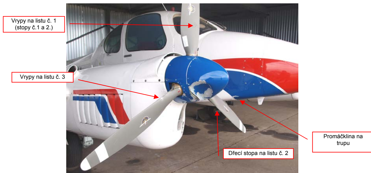
Obrázek č. 4 Stopy srážky na letounu
