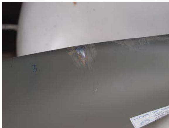
Detail poškození listu vrtule č. 3
