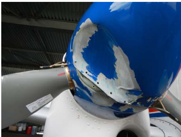
Detail poškození krytu vrtule
