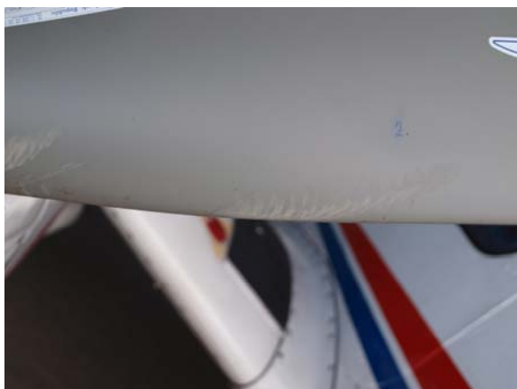
Detail stop na listu vrtule č. 2
