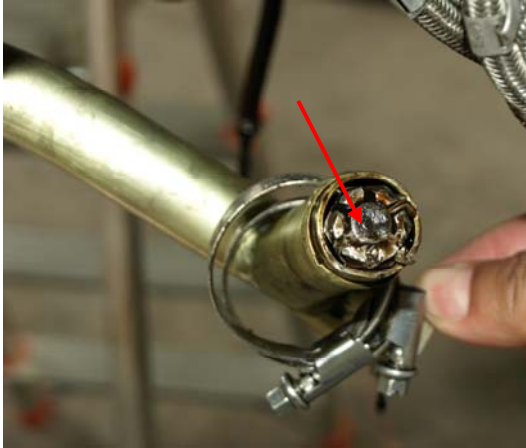
Část stahovacího šroubu s maticí v potrubí
