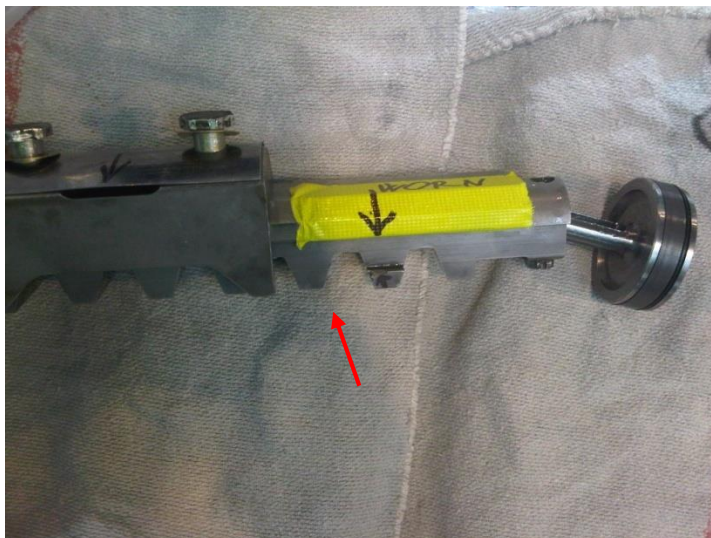
Poškození mechanismu natáčení předních kol
