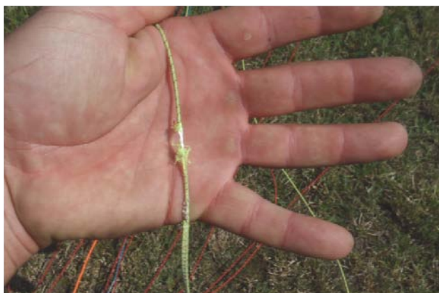
Drobná poškození šňůry a vrchlíku PK
