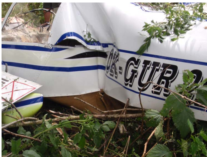
Deformace střední části trupu – levá strana.
