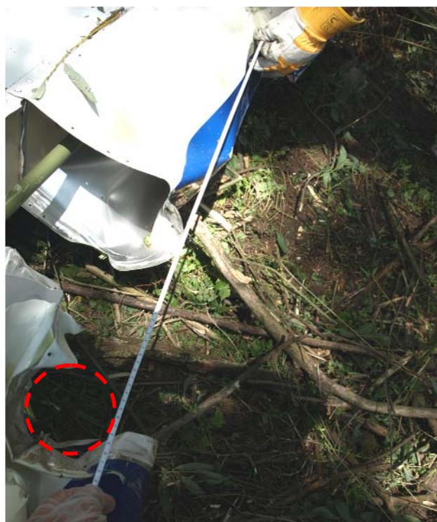
Deformace náběžné hrany a otisk kmene stromu po nárazu pravé poloviny křídla.
