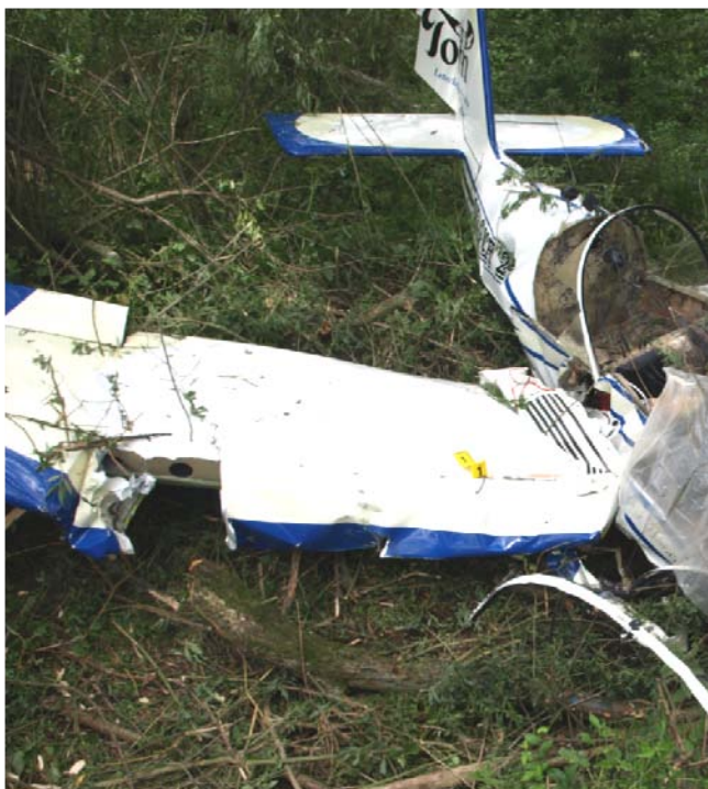
Destrukce pravé poloviny křídla nárazem do kmene stromu a větví a do země.
