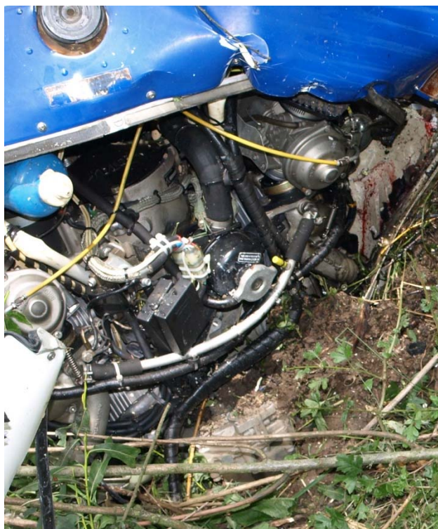
Horní strana motoru zabořeného reduktorem do země.
