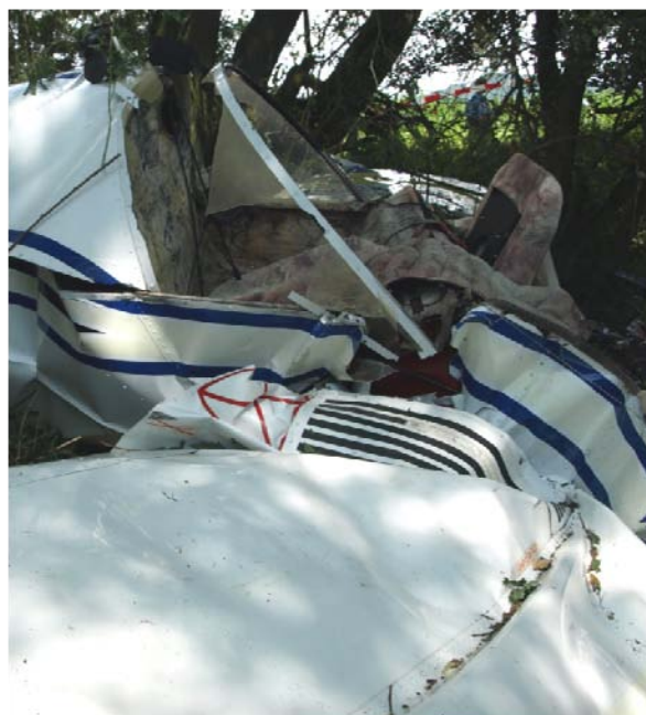
Deformace kořenové části po nárazu pravé poloviny křídla. Střední část trupu – pravá strana.
