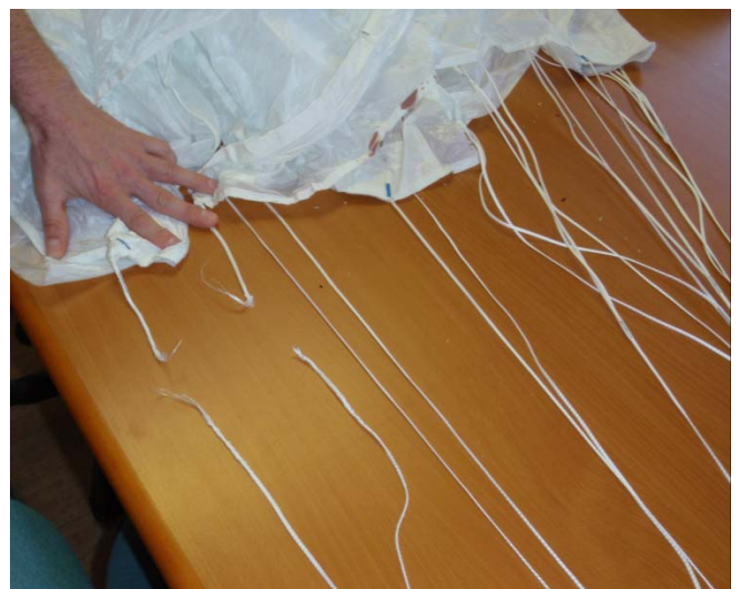
Poškození vrchlíku a šňůr záložního padáku
