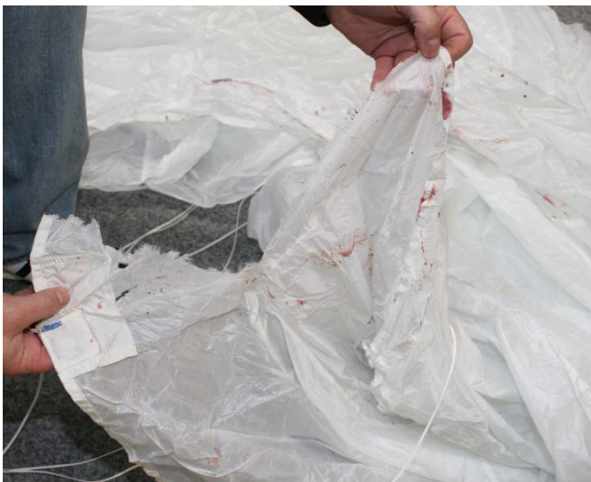
Poškození vrchlíku a šňůr záložního padáku
