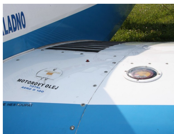
Detail polohy vysunutí mechanického ukazatele levého podvozku
