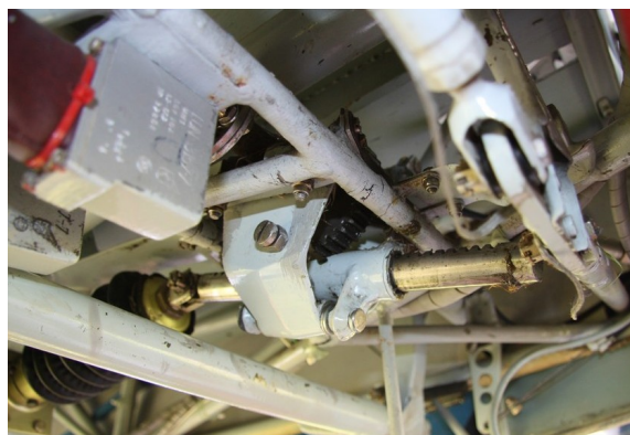
Vybočení elektrické vzpěry nahoru a poškození prutoviny (Poloha po nouzovém vysunutí podvozku)
