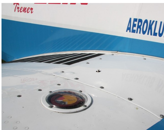
Detail polohy vysunutí mechanického ukazatele pravého podvozku
