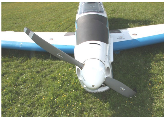
Poškození listů vrtule
