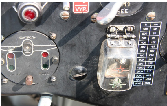
Detail polohy přepínače podvozku
