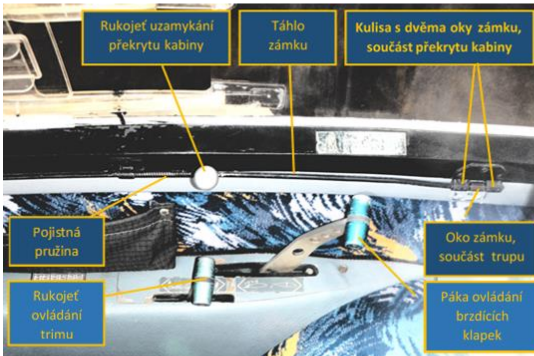
Obr. 1: Pohled na prvky systému uzamykání překrytu kabiny, tmavě modrá a ovládání brzdících klapek a trimu, světle modrá.
