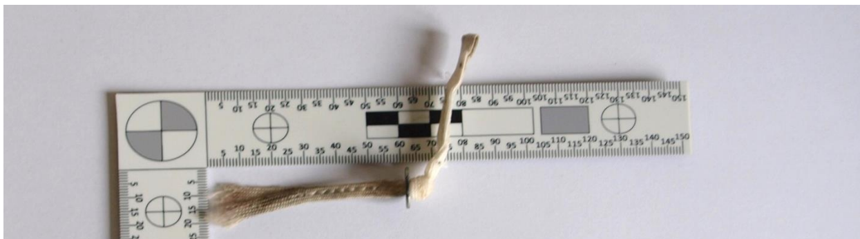
Obr. č. 2: Uzavírací šňůrka hlavního padáku s roztrženým očkem
