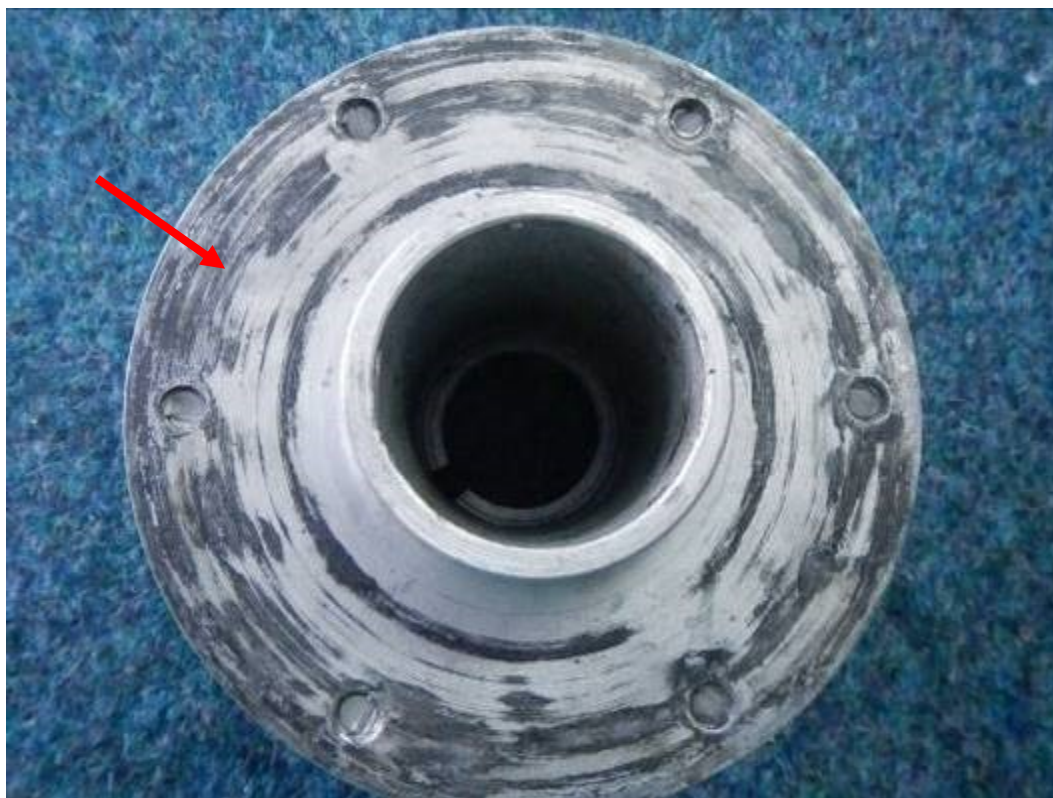
Strana unášeče s utrženými svorníky přiléhající k vložce kat. č. 726 654
