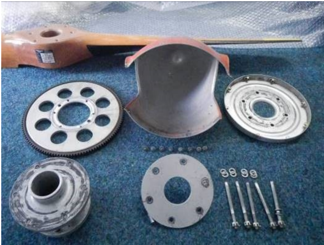
Celkový pohled na části vrtule a unášeče po demontáži
