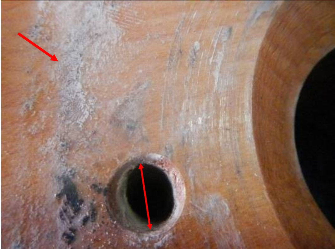
Stopy prachu na styčné ploše s vložkou a ovalita otvorů pro svorníky
