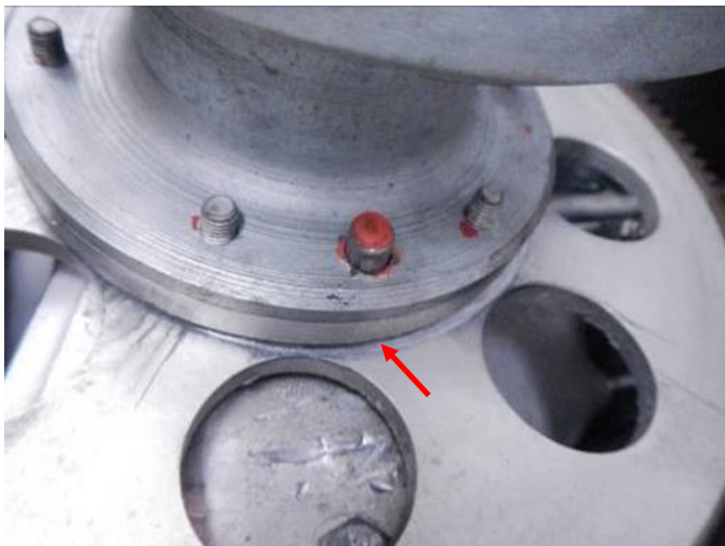
Uvolněný ozubený věnec – strana přiléhající k unášeči
