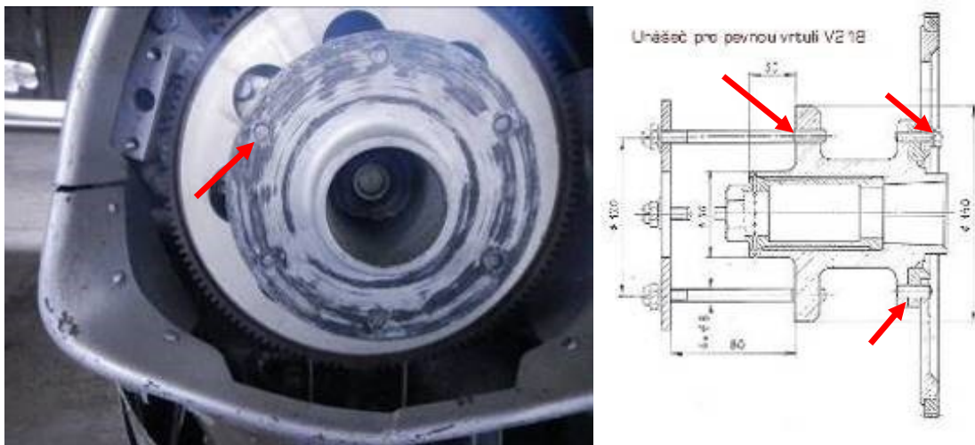
Místo ulomení svorníků na unášeči vrtule a uvolnění ozubeného věnce startování motoru
