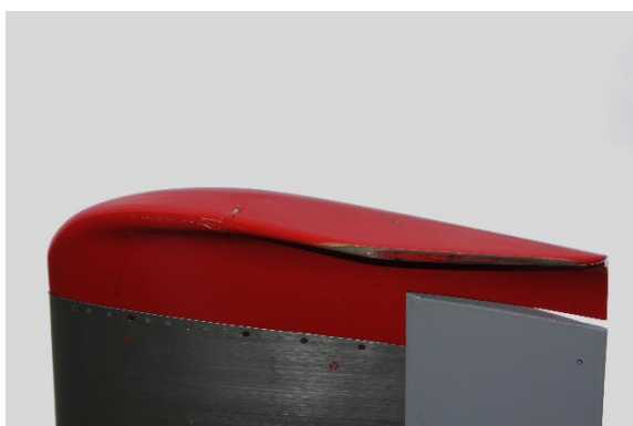
Detail poškození koncového oblouku křídla
