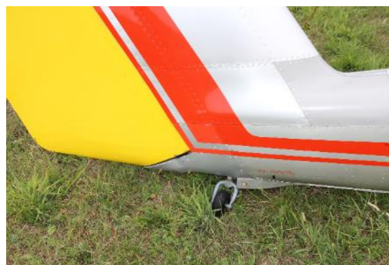
Poškození potahu v oblasti záďového podvozku
