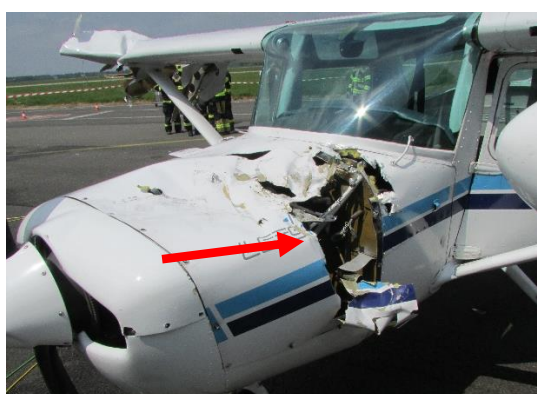
Poškození motorového lože Cessny
