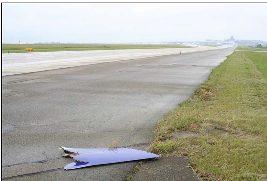
Obr. 2: Místo střetu a část wingletu z pravé poloviny křídla B737-8BK o délce cca 1,2 m
