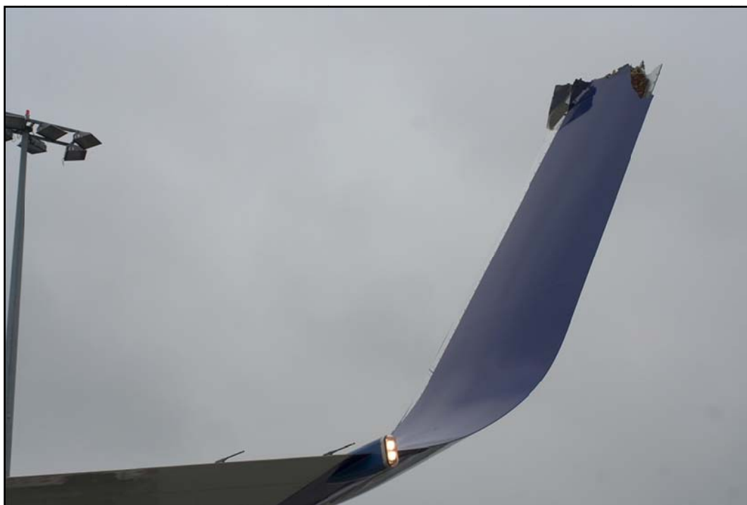
Obr. 5: Poškození wingletu na pravé polovině křídla B737-8BK
