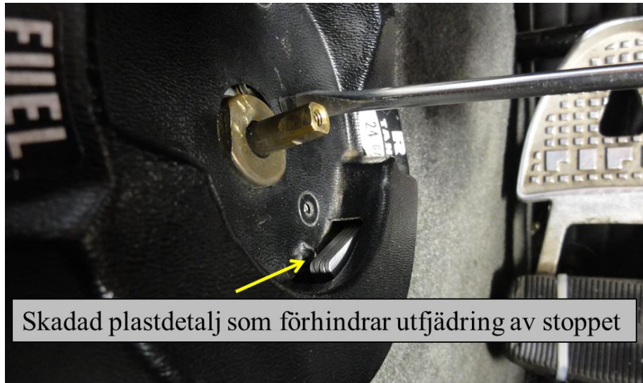
Figur 6. Tankvredets skadade plasthölje.
