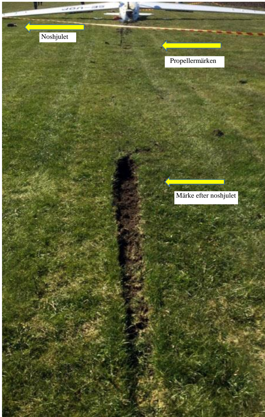
Figur 3. SE-UOP efter olyckan. Längs nedslagsplatsen syns märken från propellerislag och noshjul. Noshjulet slets av och finns även med på bilden. Foto: Peter Dorbell.
