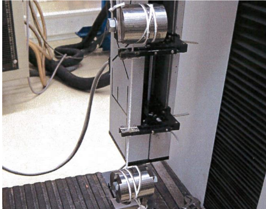
Figur 5. Provning av nylonlinan. Foto: Exova AB.
