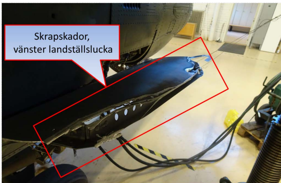
Figur 5. Vänster landställslucka med skrapmärken på luckans ovansida, vid utfällt läge.
