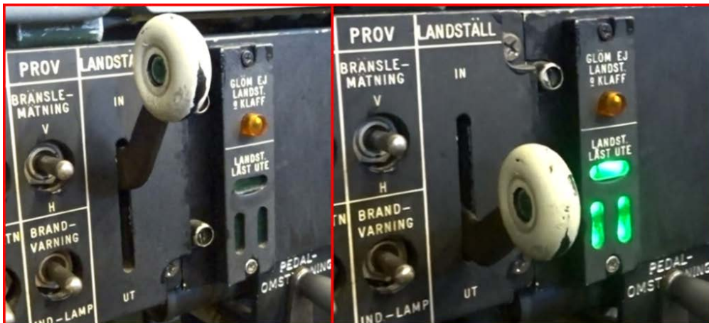
Figur 13. Vänster bild visar landställsspak i låst infällt läge och indikeringen visar landställen inne och låst. Bilden till höger visar landställsspak i låst utfällt läge och indikeringen visar att landställen är ute och låsta.
