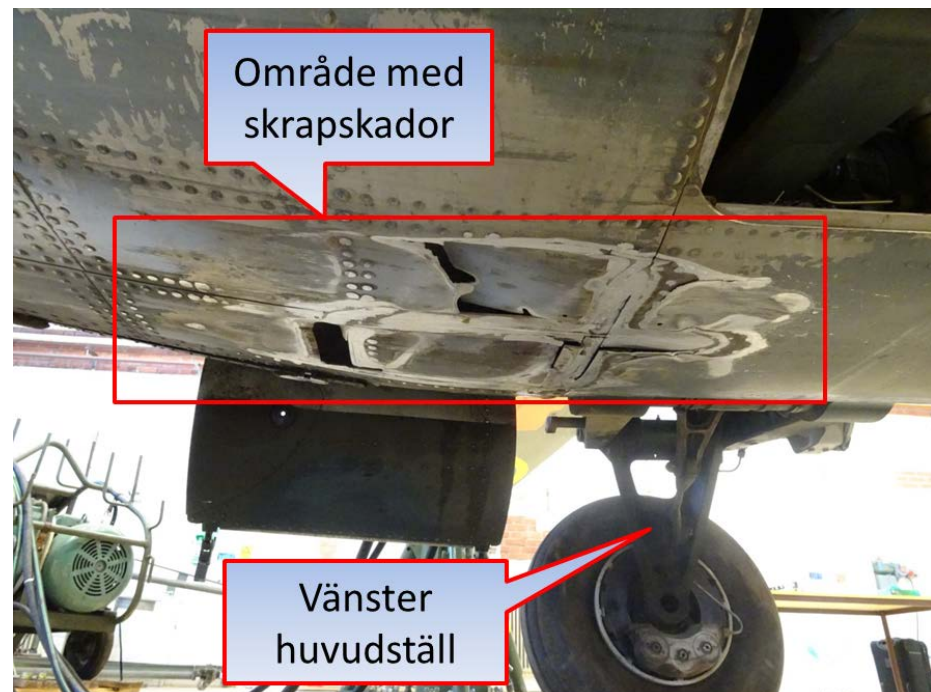
Figur 3. Bilden visar skrapskador på undersidan av flygkroppen, mellan och strax bakom landställen.
