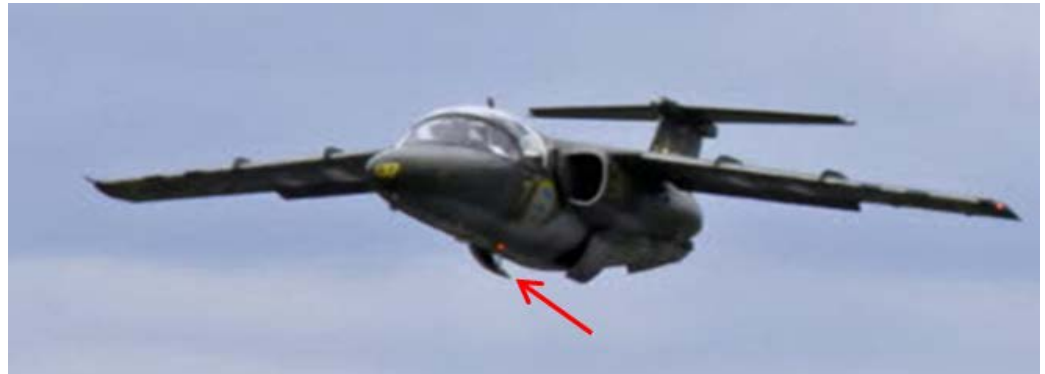
Figur 8. Utfällning av landställ SK 60, luckorna för huvudställen har börjat öppna sig. Foto: Försvarsmakten.
