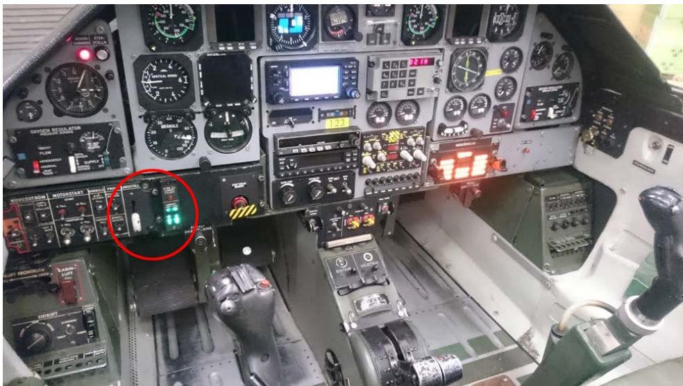
Figur 10. Placering av landställsreglage och landställsindikering i kabinen.
