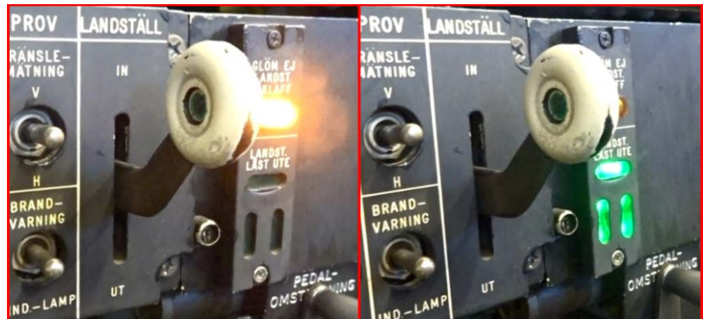
Figur 14. Vänster bild visar landställsreglaget i mellanläget utan att vara låst, landställerna infällda. Den gula lampan blinkar och indikerar att klaffarna är utfällda men inte landstället. Höger bild visar landställsreglaget i mellanläget utan att vara låst, de gröna lamporna indikerar att landställerna är ute och låsta.
