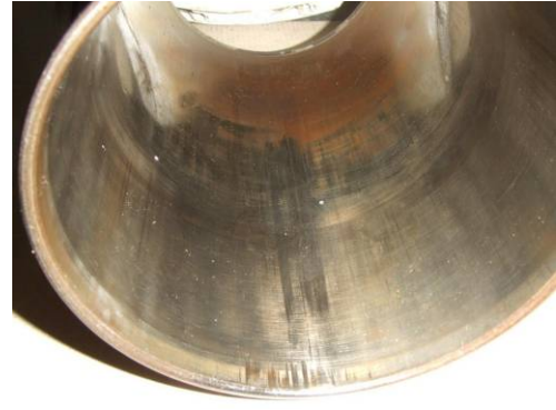
Abb. 6: Spuren von Reibung im Zylinder Nr. 2
