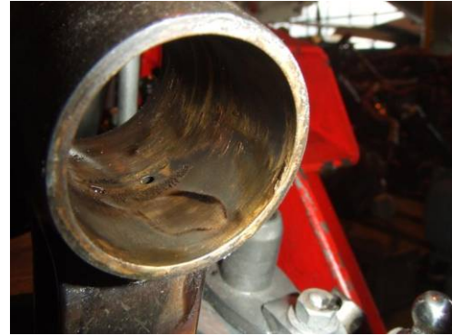
Abb. 4: Pleuelbuchse des Zylinders Nr. 2
