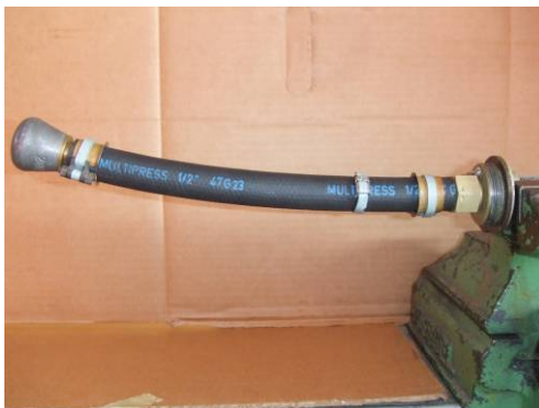
Abb. 7: In der HB-UUT montierter Schlauch
