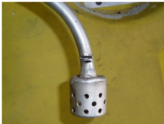
Abbildung 5: Beschädigtes Saugrohr mit Grobfilter
